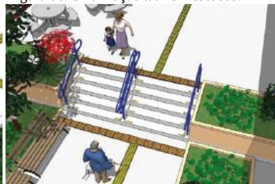
Figura 06. Sinalização tátil em escadas.
