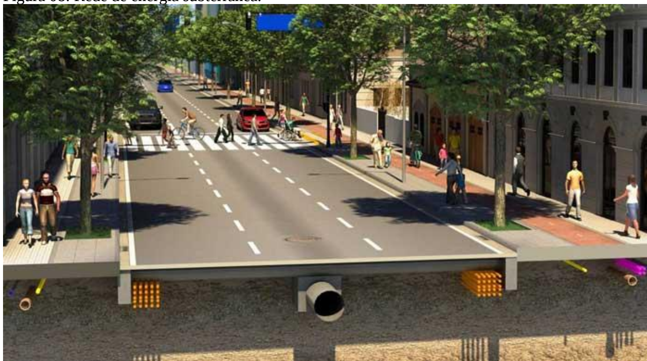
Figura 08: Rede de energia subterrânea.
