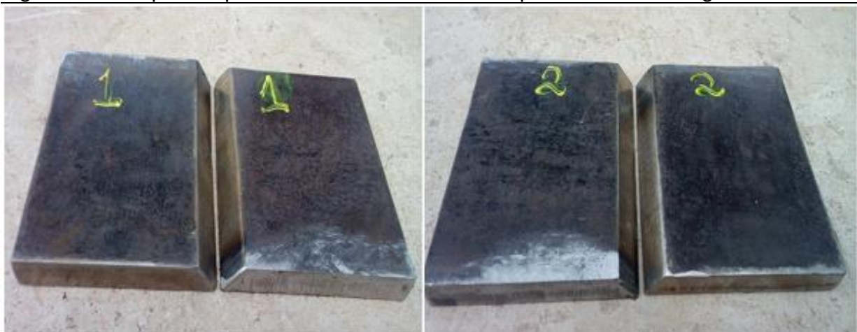
Figura 14 - Corpos de provas com chanfro antes do processo de soldagem.
