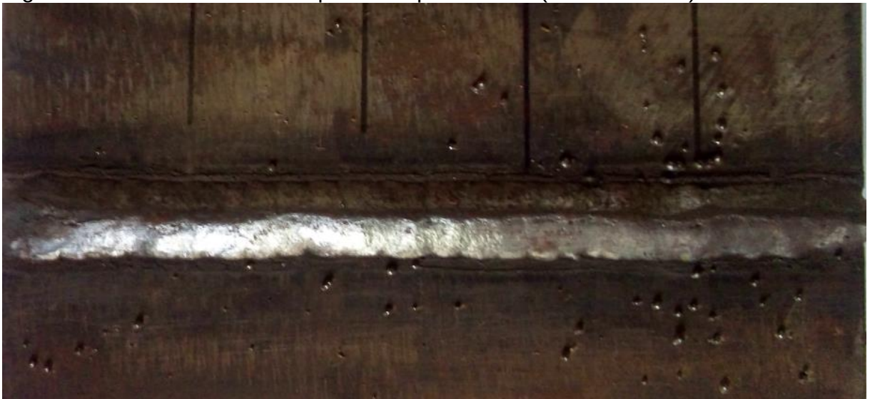
Figura 23 - Efeito da DBCP no processo para XLR-8 (DBCP-15 mm).
