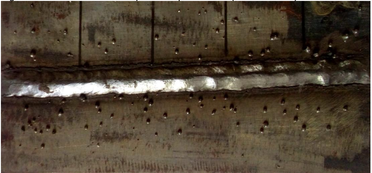
Figura 22 - Efeito da DBCP no processo para XLR-8 (DBCP-20 mm).
