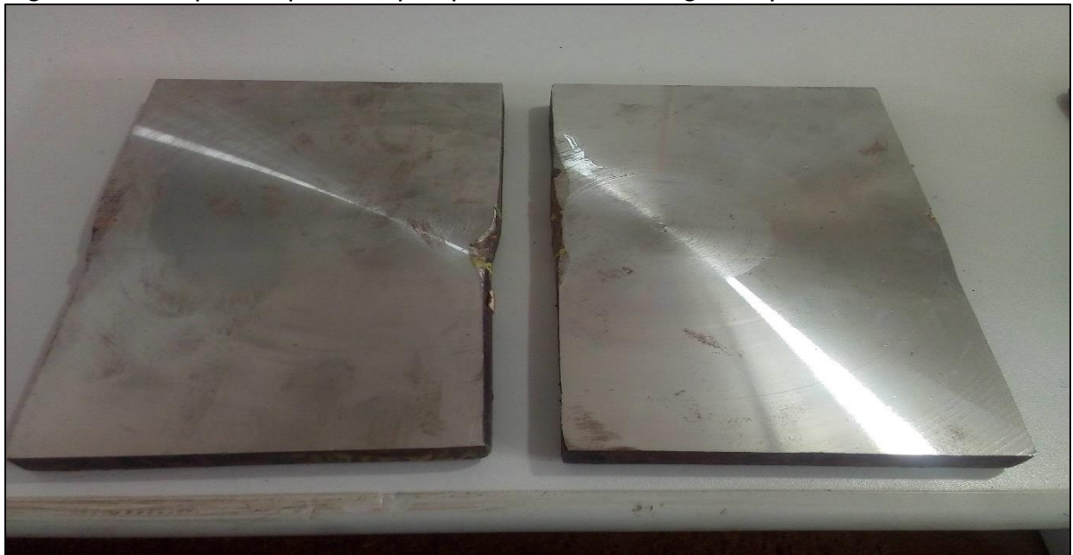
Figura 15 - Corpos de provas após processo de soldagem e polimento.
