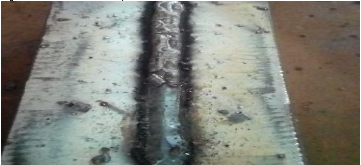
Figura 21 - Cordão de solda parâmetro treze HORBAT.
