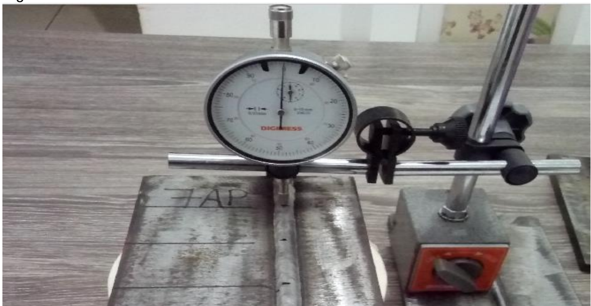
Figura 19 - Leitura da altura do cordão de solda.
