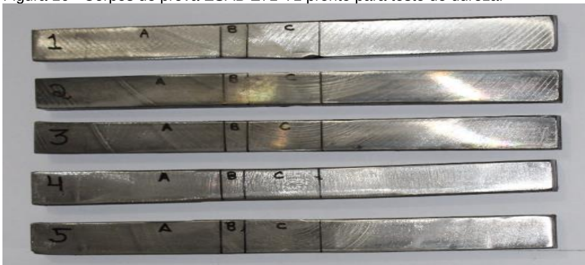
Figura 16 - Corpos de prova ESAB E71-T1 pronto para teste de dureza.
