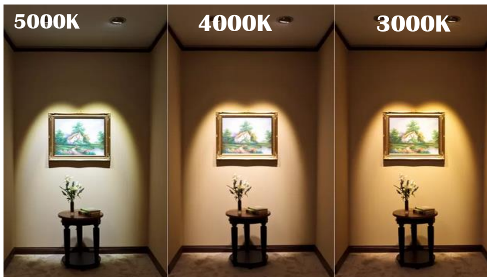
Imagem 2: Mudança da temperatura de cor de fria para quente em um mesmo ambiente.
