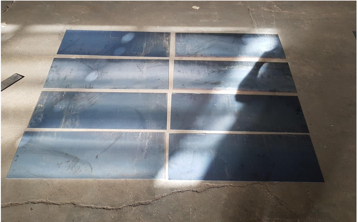
Figura 17 - Chapas do costado recortadas
