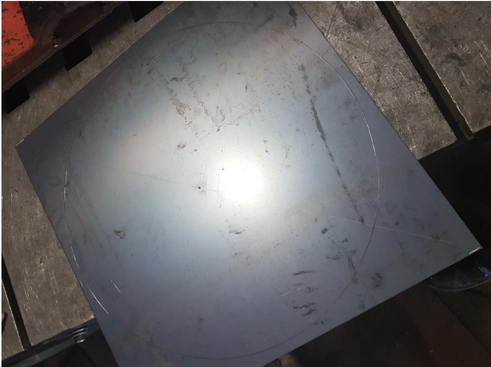
Figura 16 - Marcação para corte fundo e teto
