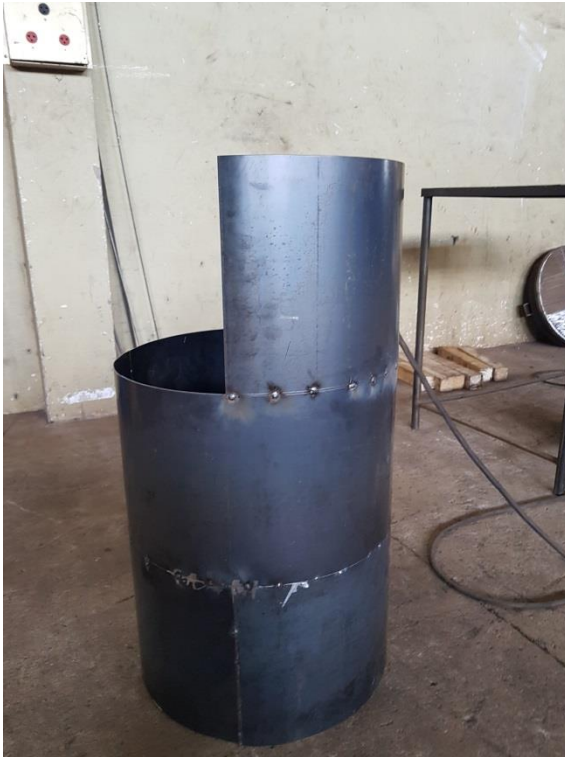
Figura 19 - Processo de solda para montagem do modelo
