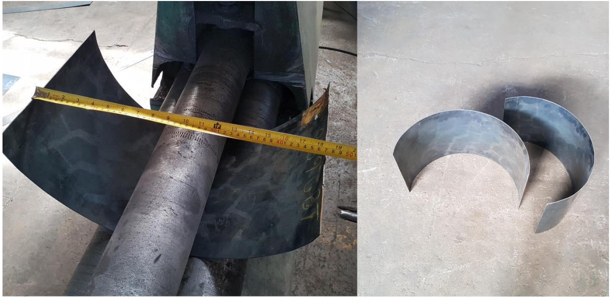
Figura 18 - Chapa costado calandrada
