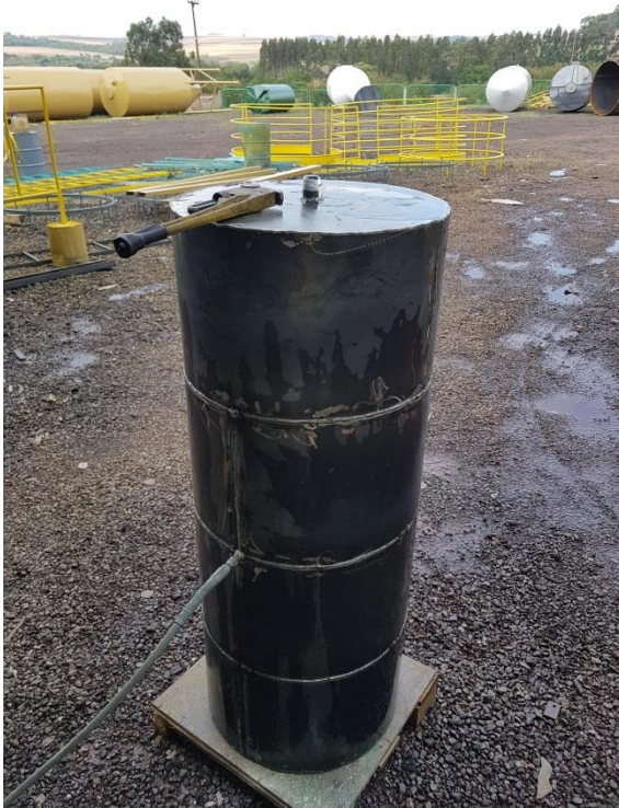
Figura 21 - Reservatório completamente cheio para início do teste hidrostático.
