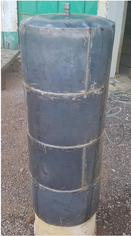
Figura 22 - Reservatório a 20% da pressão máxima
