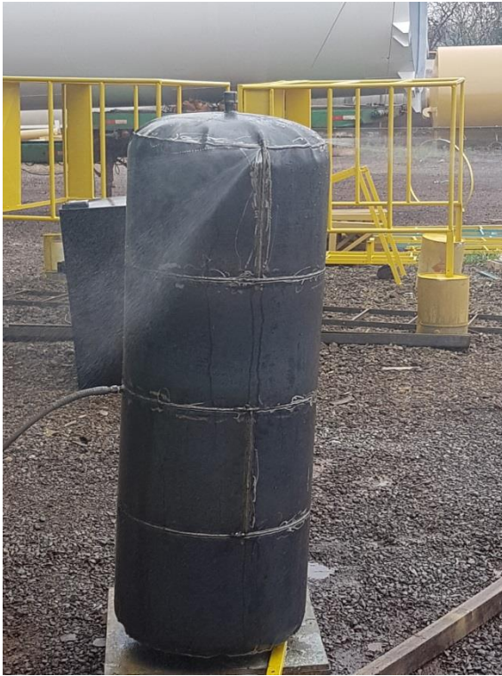
Figura 23 - Reservatório a 40% da pressão máxima
