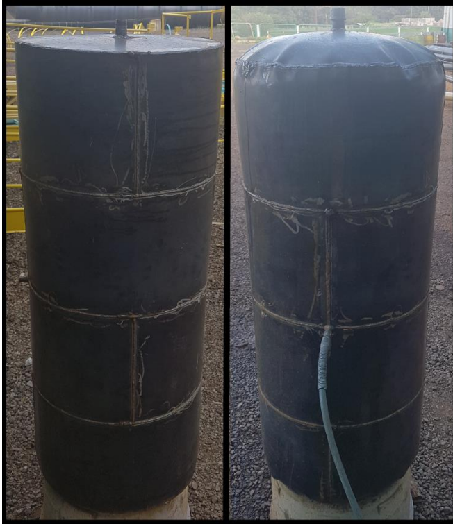
Figura 24 - Comparação modelo antes e após teste hidrostático
