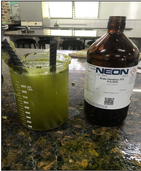
Figura 12: Limpeza das barras.
