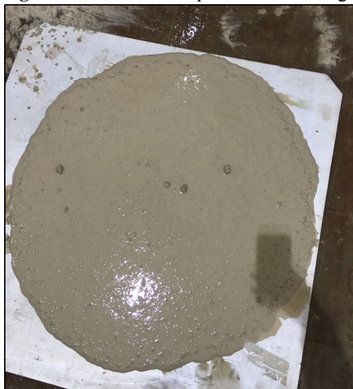
Figura 14: Ensaio de espalhamento do segundo traço.
