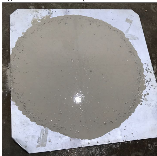
Figura 15: Ensaio de espalhamento do terceiro traço.
