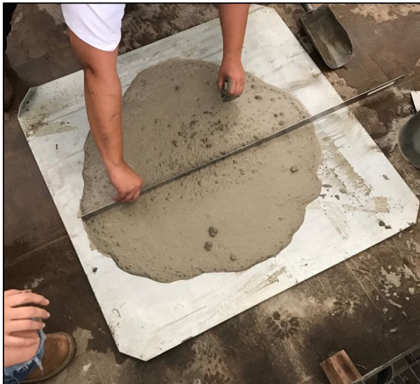
Figura 13: Ensaio de espalhamento do primeiro traço.
