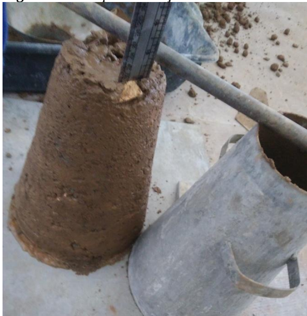
Figura 10: Slump test – traço 50%+AD com aditivo.
