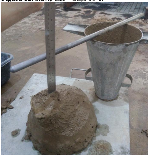
Figura 12: Slump test – traço 50%.
