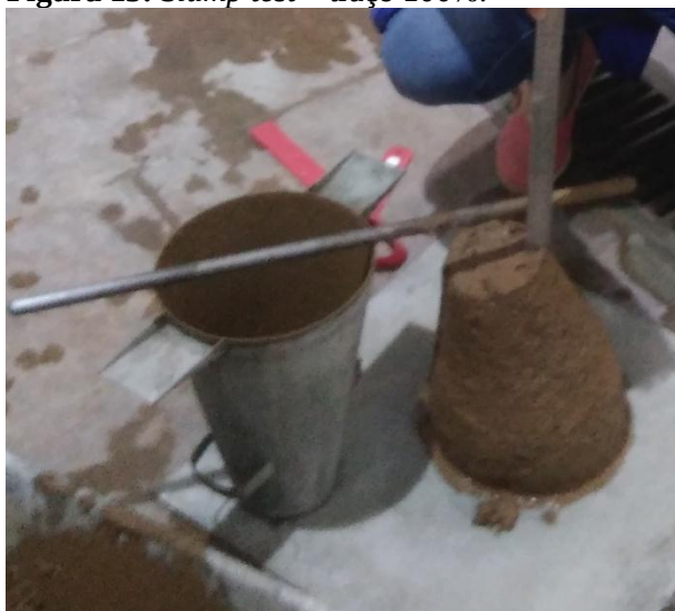
Figura 13: Slump test – traço 100%.
