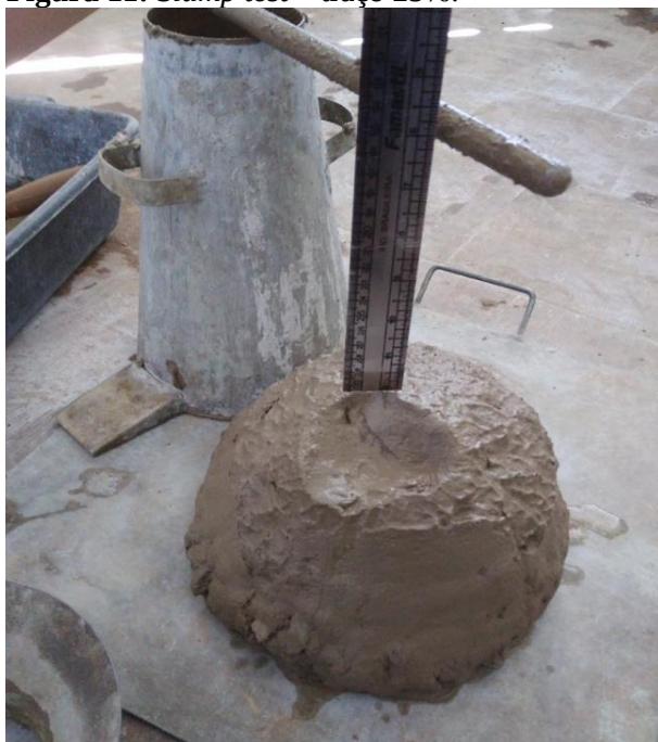
Figura 11: Slump test – traço 25%.
