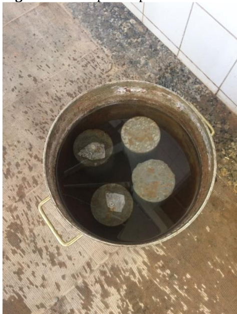
Figura 10 - Corpos de prova submersos em água para ensaio de absorção.
