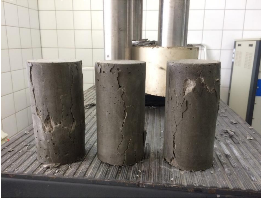
Figura 14 - Corpo de prova com filer de pó de mármore após ensaio de resistência à compressão.
