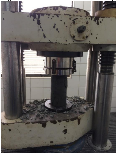
Figura 8 - Ensaio de resistência à compressão.
