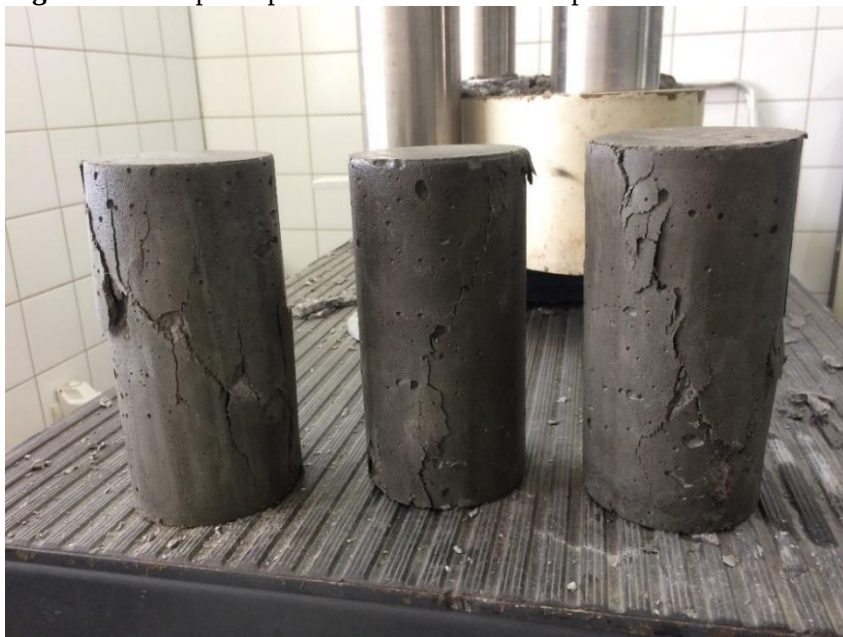
Figura 13 - Corpo de prova com filer de CCA após ensaio de resistência à compressão.
