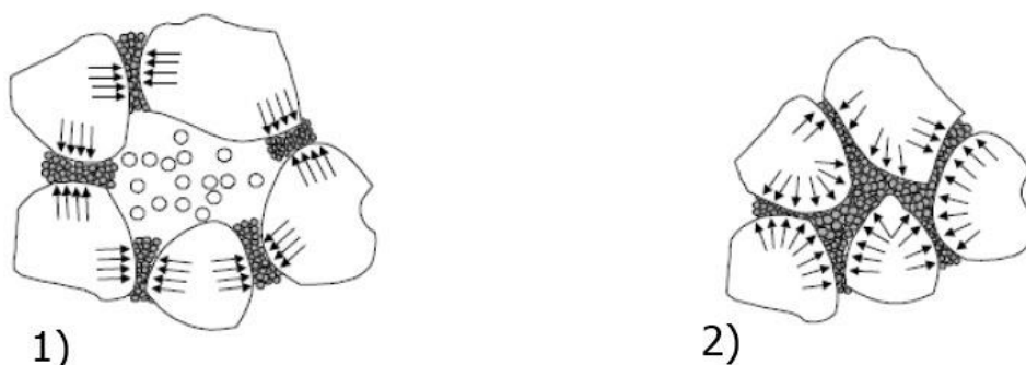
Figura 2: Estrutura solo colapsível
