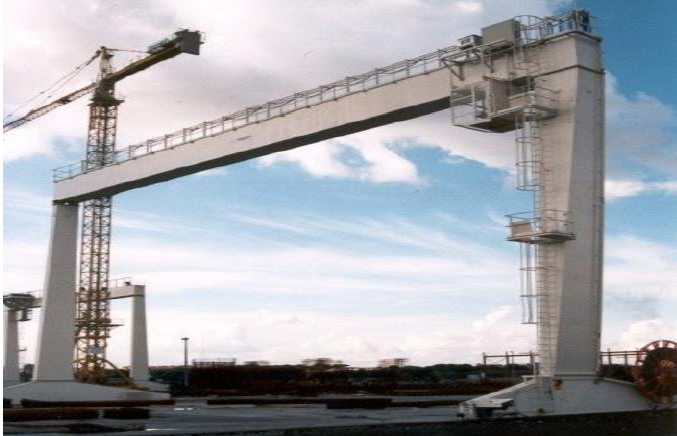
Figura 2 – Pórtico Monoviga Caixaão
