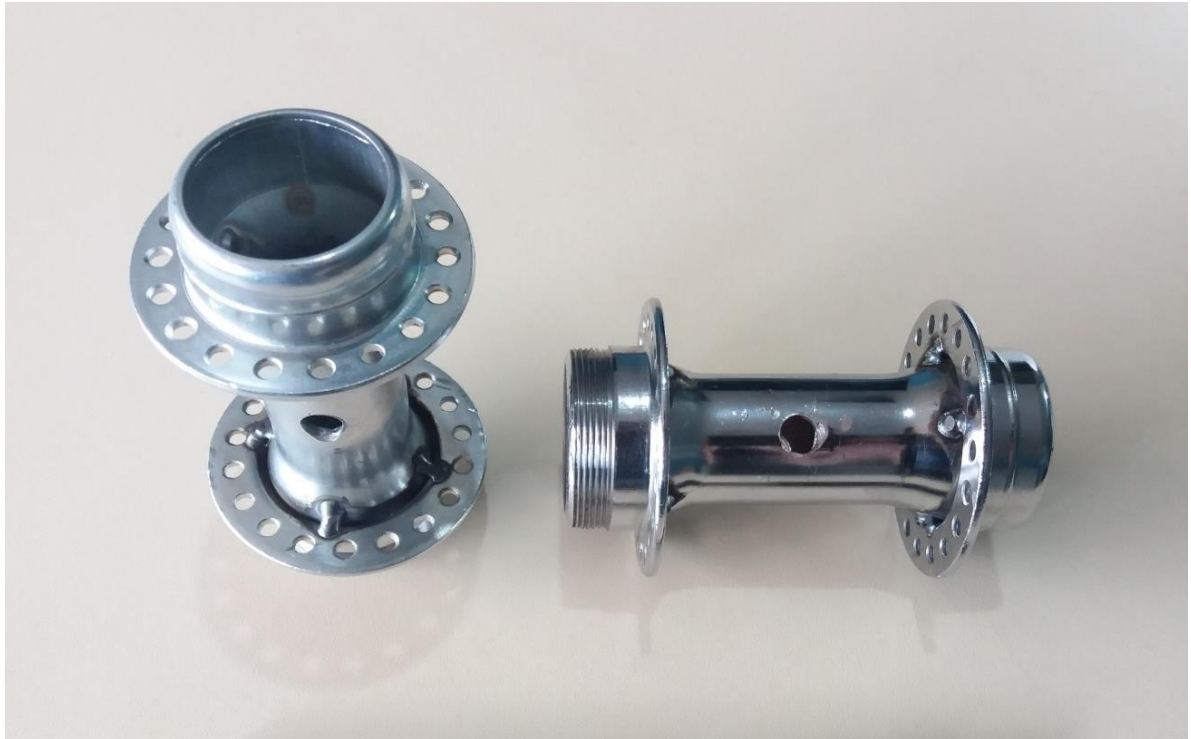
Figura 29: Realização dos furos e solda nos cubos metálicos.
