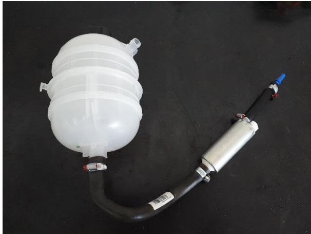
Figura 4 - Reservatório expansão e Bomba
