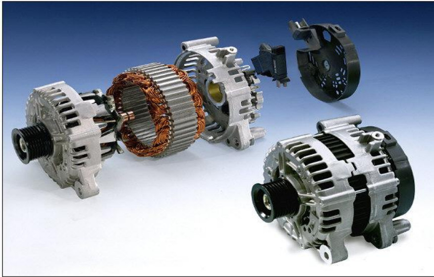
Figura 10 - Alternador e seus componentes
