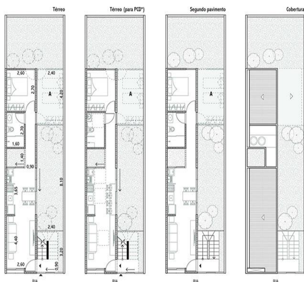
Figura 13: Planta de Casa Sobreposta
