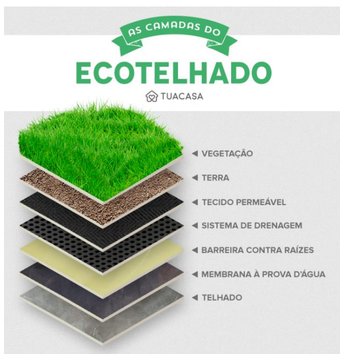
Figura 05: Funcionalidade de um Telhado Verde
