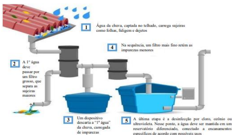
Figura 04: ilustra um exemplo de sistema de captação e aproveitamento de águas pluviais.
