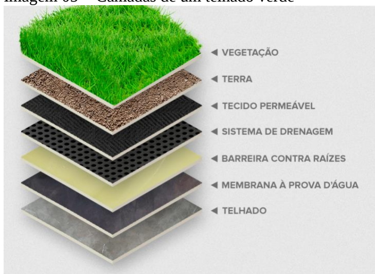
Imagem 05 - Camadas de um telhado verde
