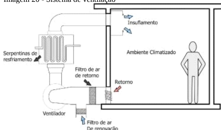
Imagem 20 - Sistema de ventilação
