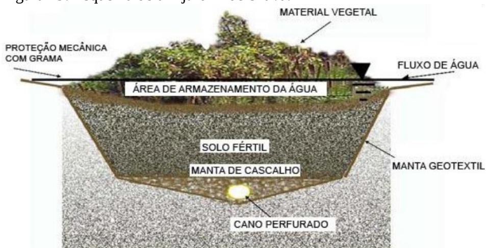
Figura 19: Esquema de um jardim de chuva.
