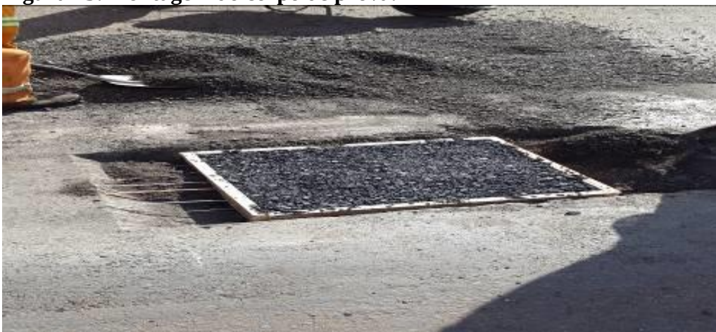
Figura 13: montagem do corpo de prova.
