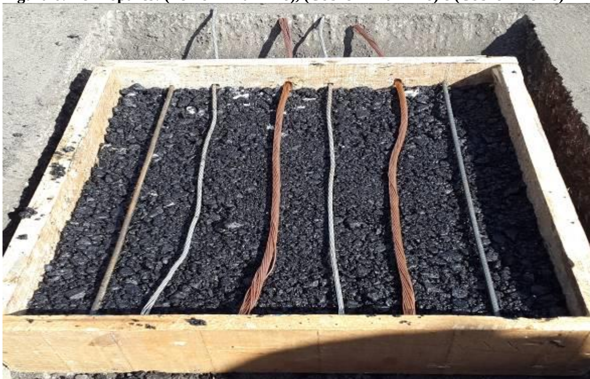
Figura 6: Termopares: (Ferro + Alumínio), (Cobre + Alumínio) e (Cobre + Ferro)
