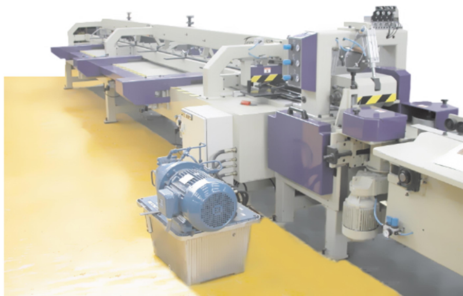
Figura 11- Estação de pré-prensagem
