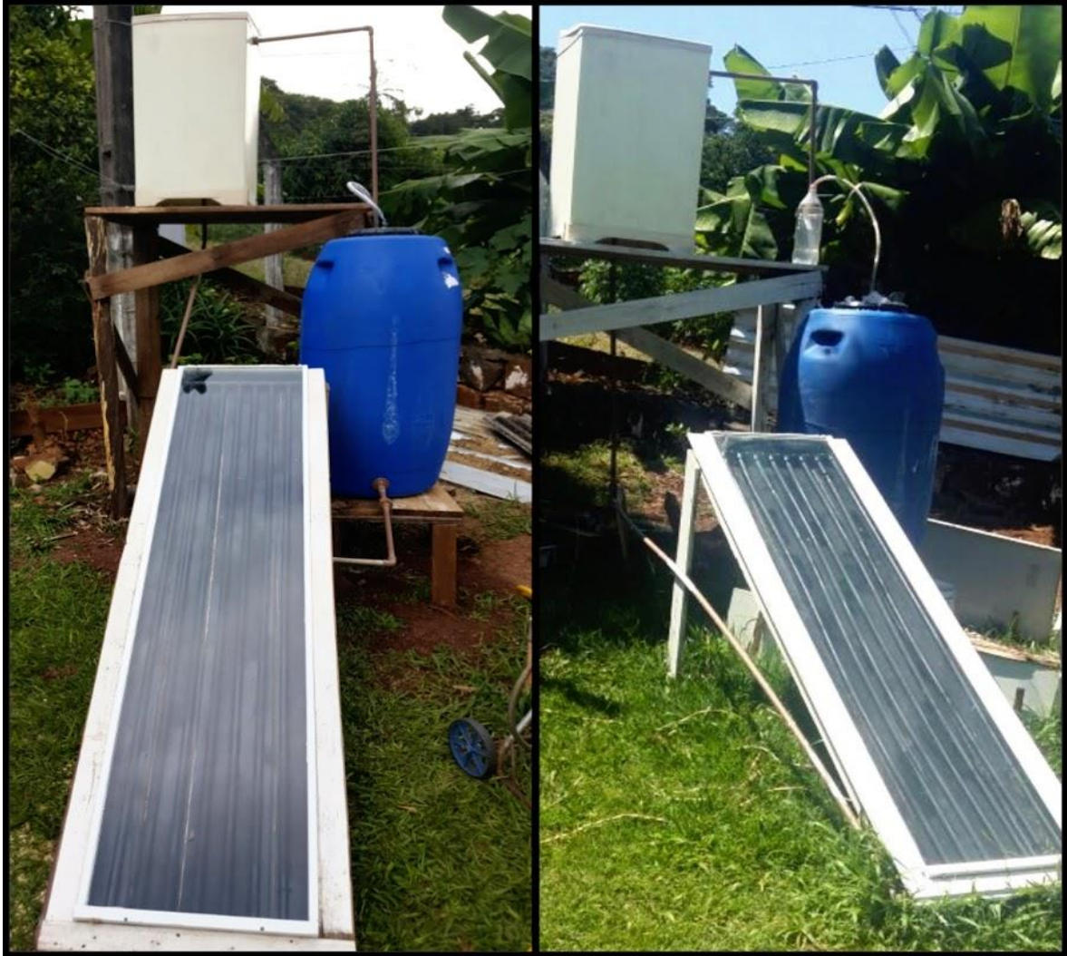
Figura 11 – Protótipo de biodigestor aquecido com sistema de aquecimento.
