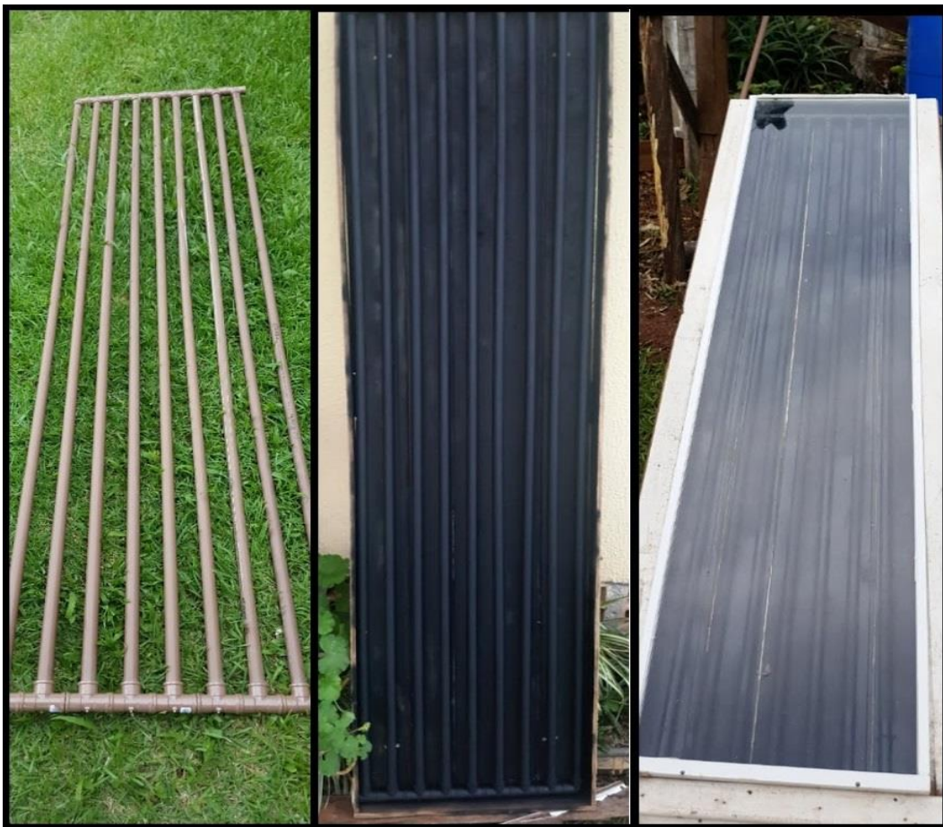
Figura 9 – Etapas de fabricação do coletor solar fechado plano.
