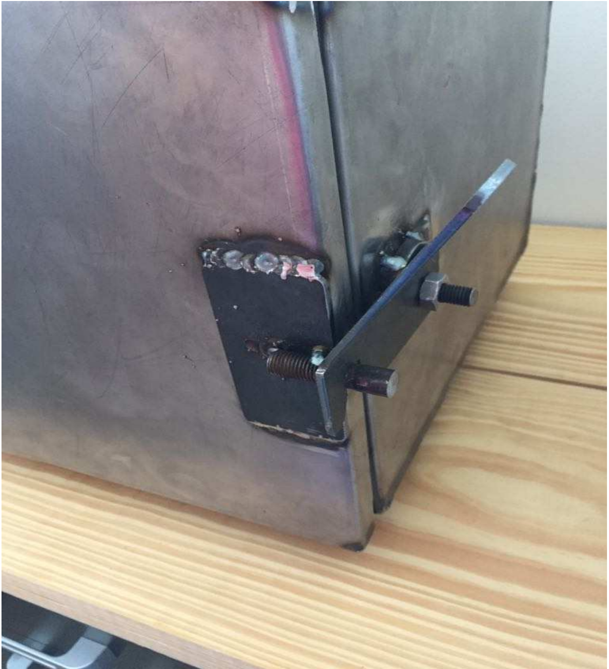
Figura 15: Caixa fechada, com o sistema de fechadura em funcionamento, dando o aperto necessário para não haver a saída de ruídos.
