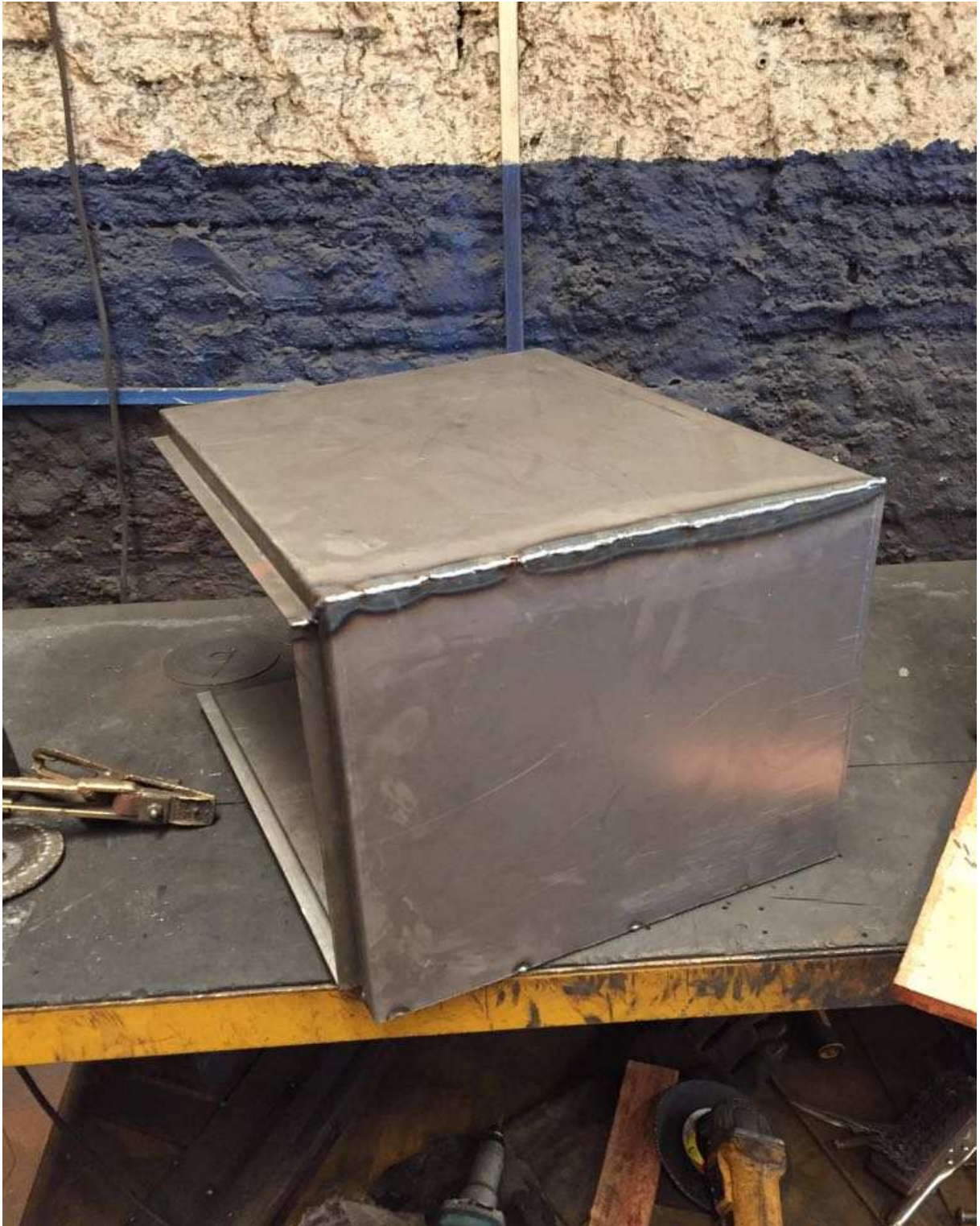
Figura 12: Início da montagem do protótipo, com uma de suas arestas já soldada.
