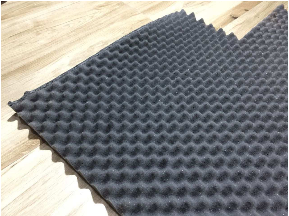
Figura 6: Placa de espuma acústica de poliuretano 25mm utilizada na montagem do protótipo.
