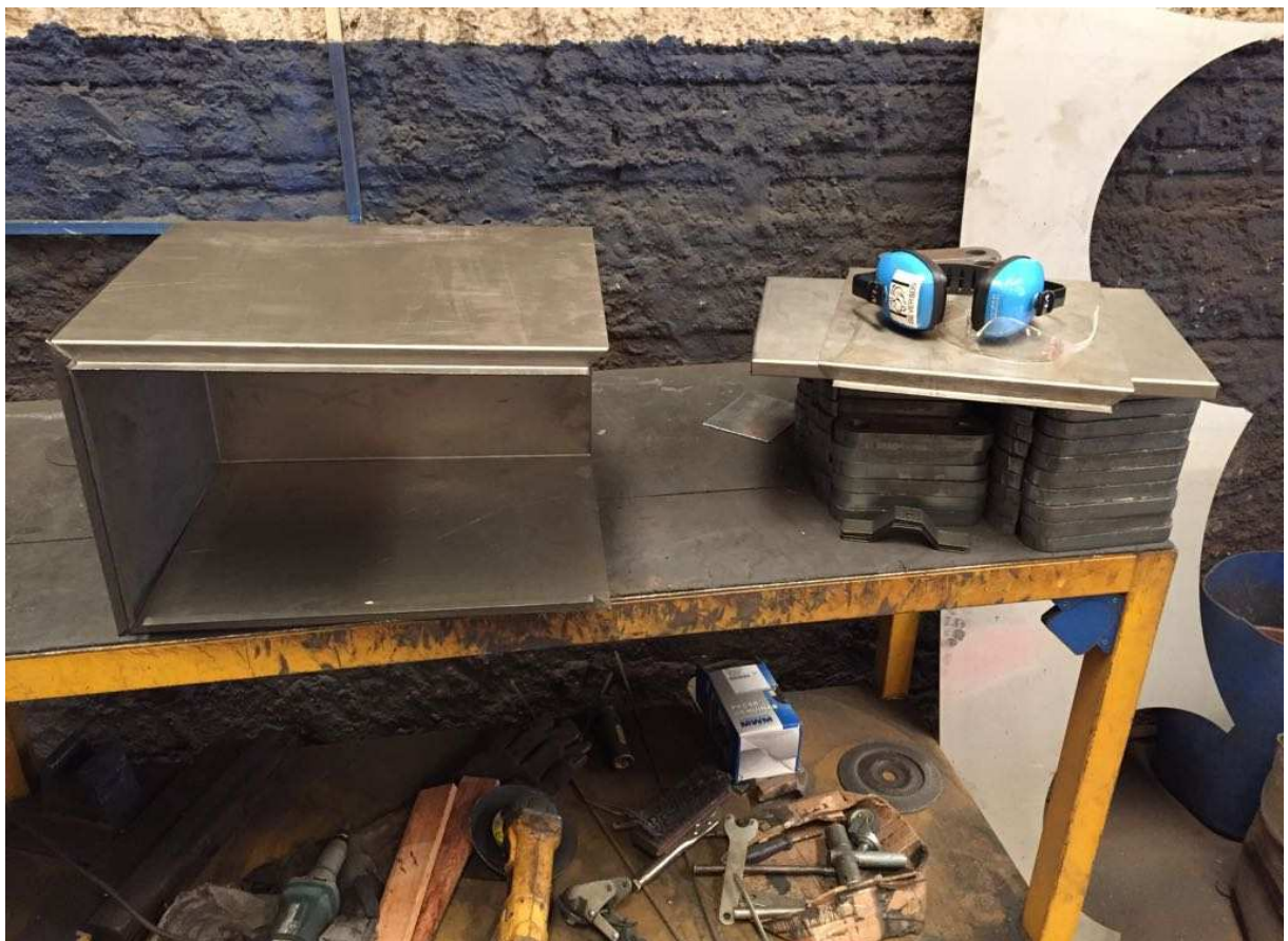
Figura 11: Protótipo com suas chapas cortadas e dobradas, aguardando o processo de solda.
