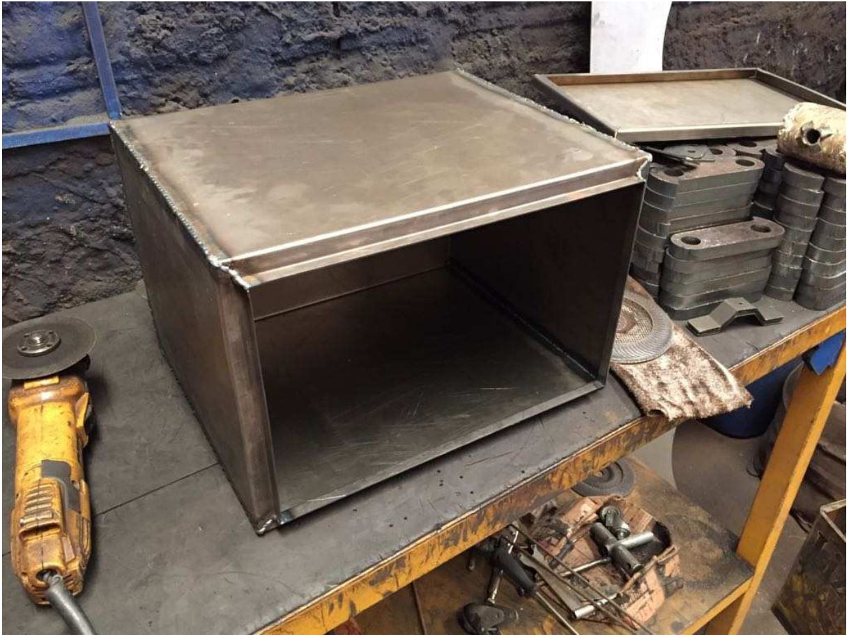
Figura 13: Arestas do protótipo soldadas, faltando apenas os apoios para os pés de borracha e as dobradiças para a fixação da porta.
