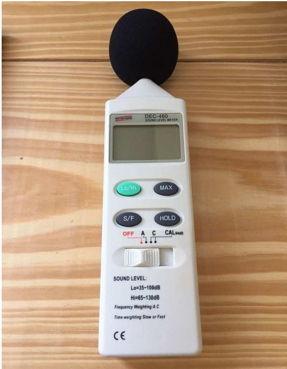
Figura 7: Decibelímetro modelo DEC-460, da marca Instrutherm, utilizado na realização dos ensaios do protótipo.
