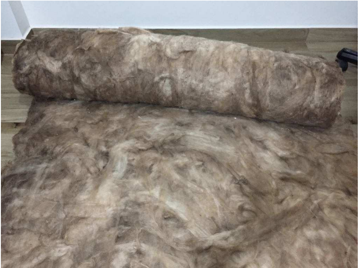
Figura 5: Manta de lã de vidro de 20mm de espessura utilizada na montagem do protótipo.
