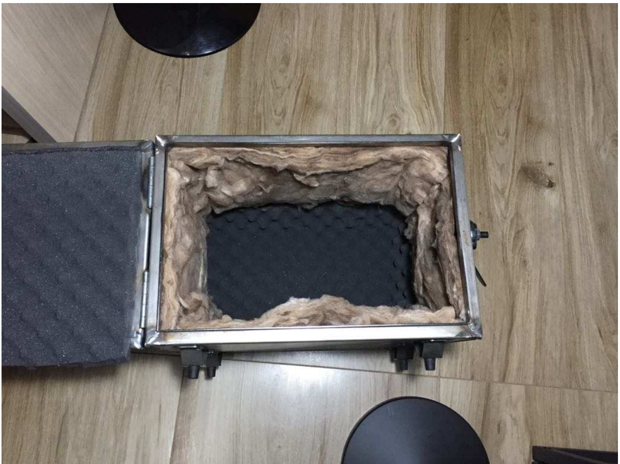
Figura 16: Finalização da montagem do protótipo. No fundo, camada de espuma de poliuretano e nas laterais manta de lã de vidro.
