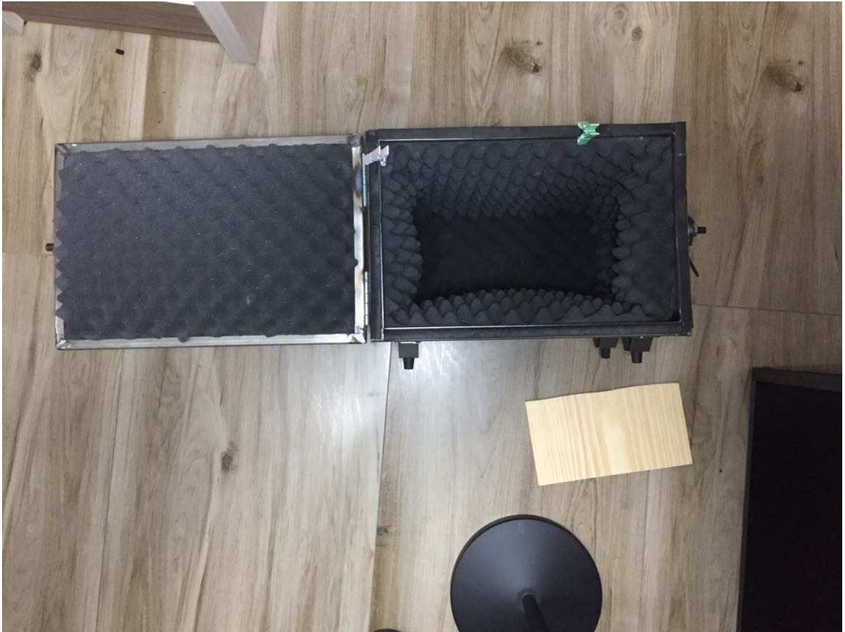
Figura 17: Protótipo finalizado, com todas as camadas de material isolante.
