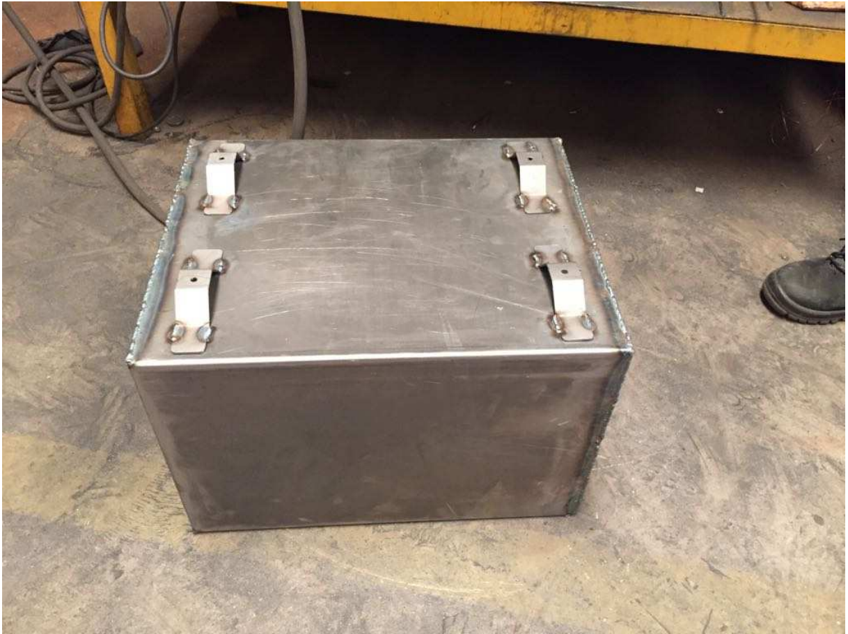
Figura 14: Fundo da caixa, com os apoios para os pés de borracha, soldados.
