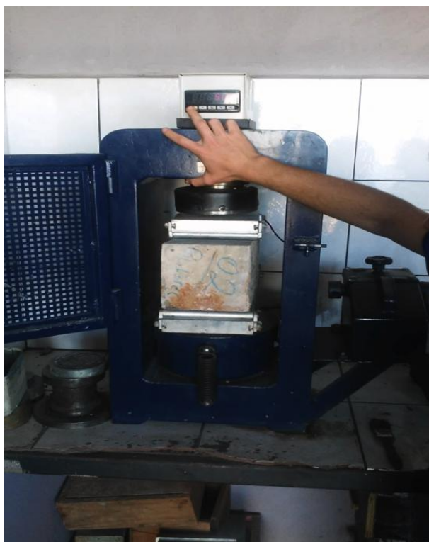
Figura 3: Ensaio de resistência à tração em corpos de prova prismáticos.
