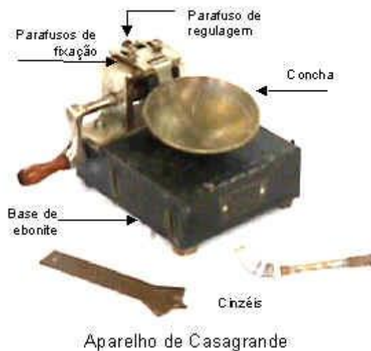
Figura 5: Aparelho de Casagrande.
