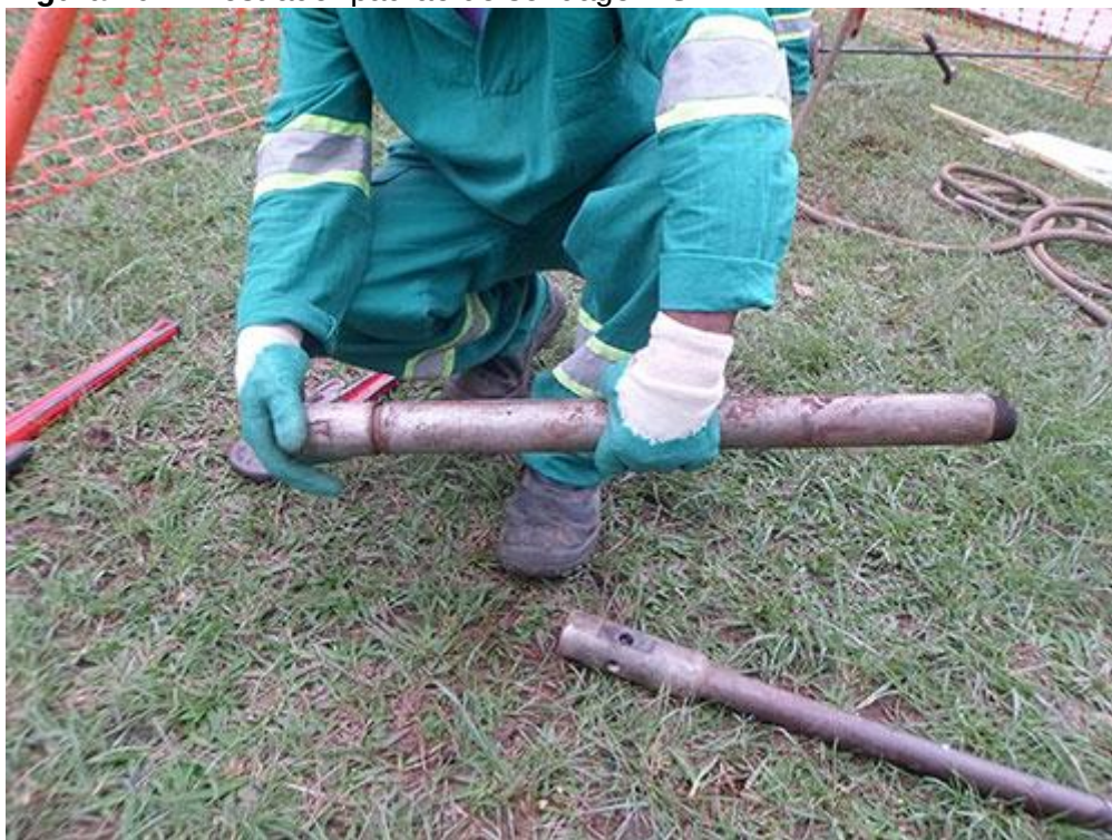
Figura 10: Amostrador padrão de sondagem SPT.
