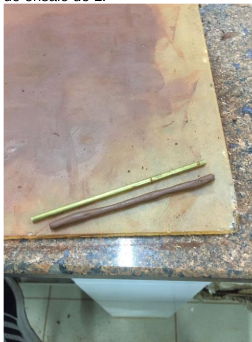
Figura 22: Amostra comparada ao gabarito do ensaio de LP
