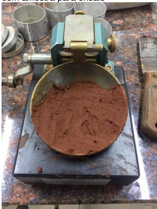
Figura 21: Aparelho de Casagrande com amostra para ensaio
