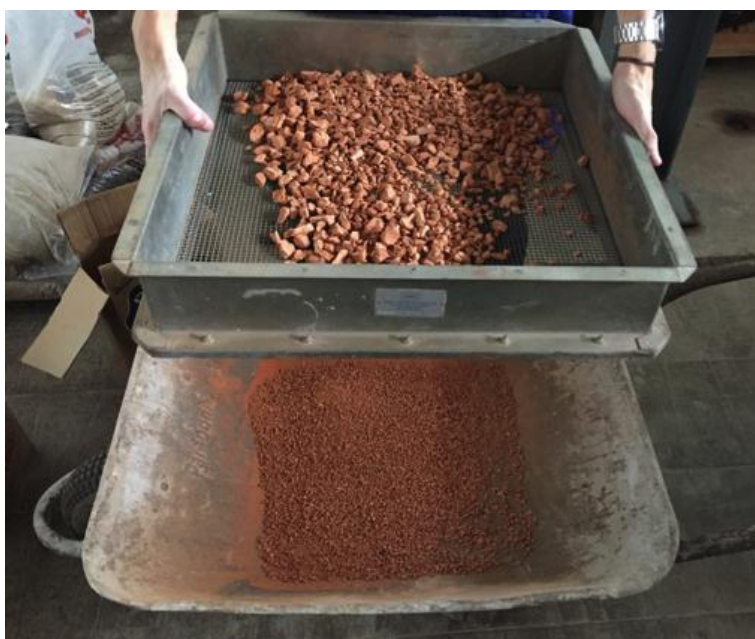
Figura 6: Separação dos materiais RCD.
