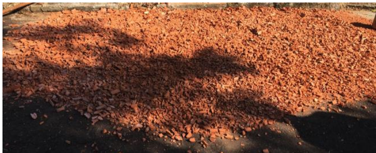
Figura 5: Camada triturada de tijolos.
