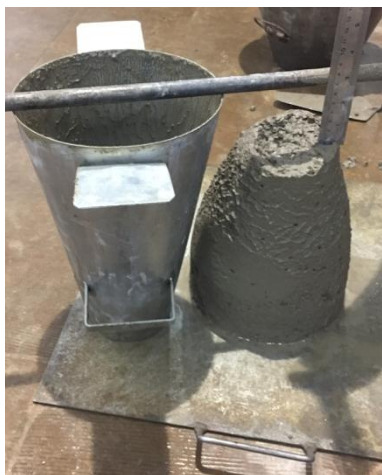
Figura 17: Medida do ensaio de abatimento do tronco de cone.
