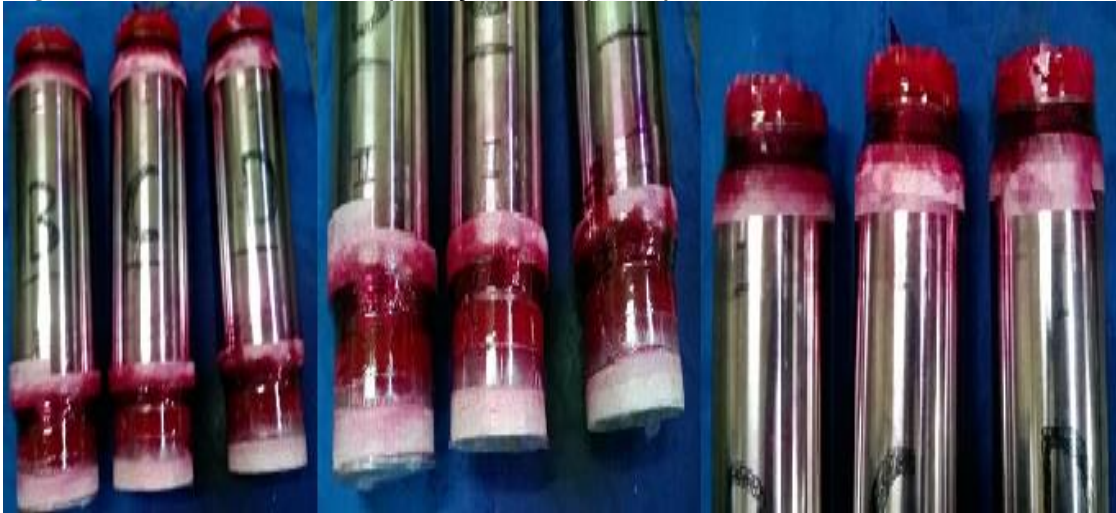
Figura 35 - Cilindros com aplicação do líquido penetrante
