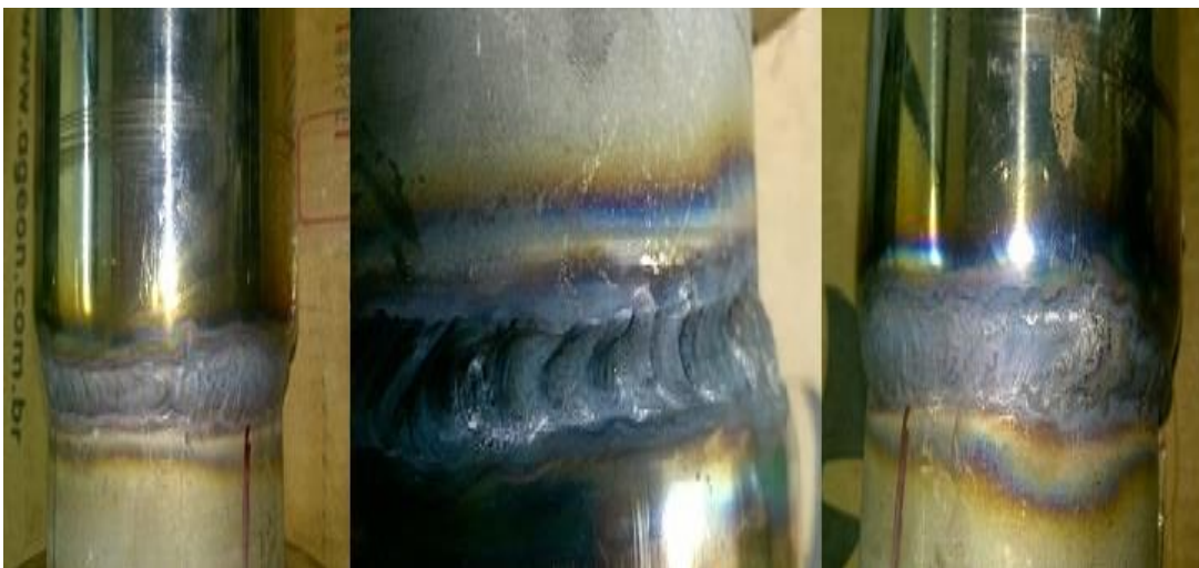
Figura 24 - Cordão de solda realizado por soldador menos experiente
