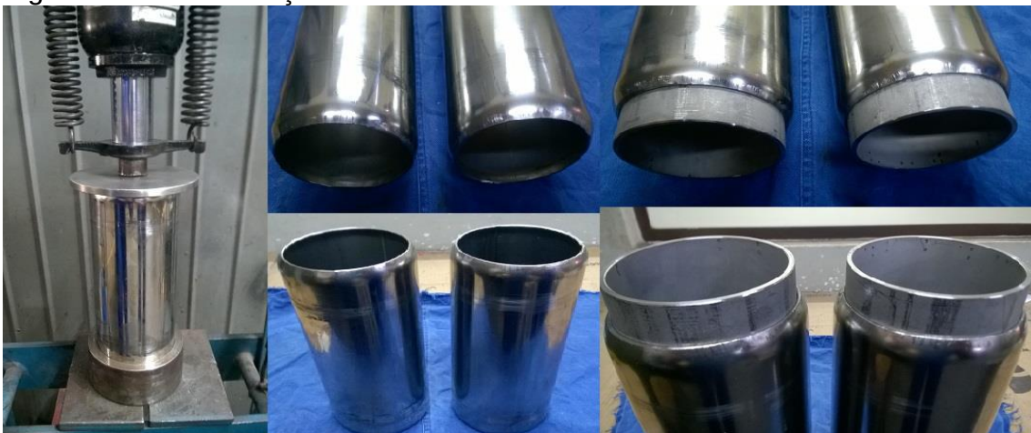
Figura 11 - Conformação do tubo externo
