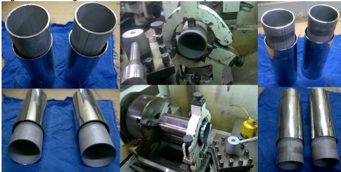
Figura 7 - Usinagem dos tubos do cilindro evaporador
