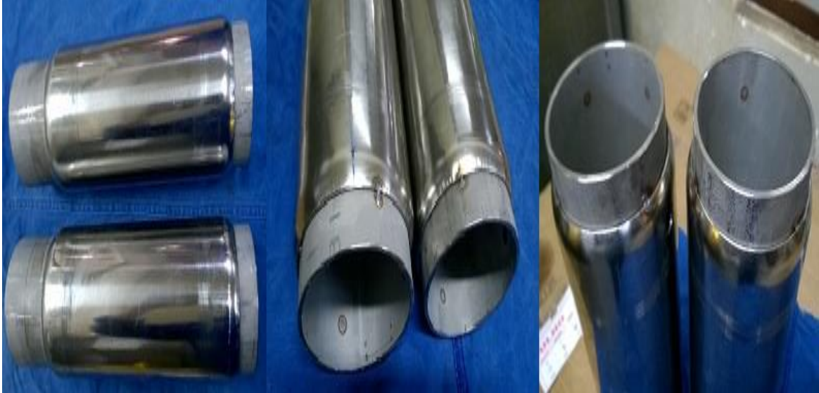
Figura 31 - Tubos preparados para operação de soldagem
