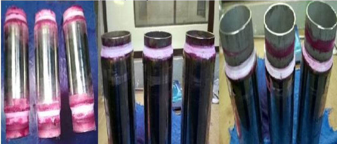
Figura 37 - Cilindros após aplicação do revelador
