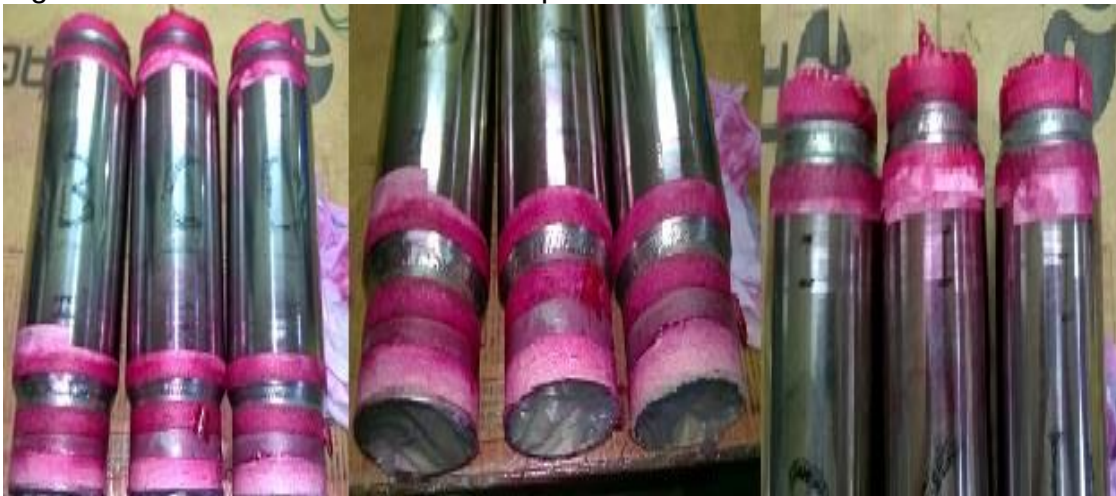
Figura 36 - Cilindros com excesso de penetrante removido
