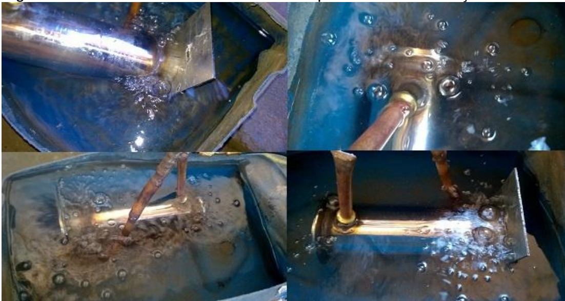
Figura 25 - Vazamento detectado ainda no processo de fabricação
