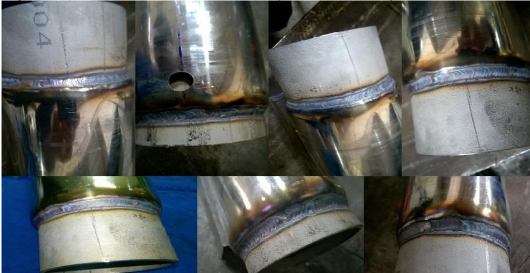
Figura 23 - Cordão de solda realizado por soldador experiente
