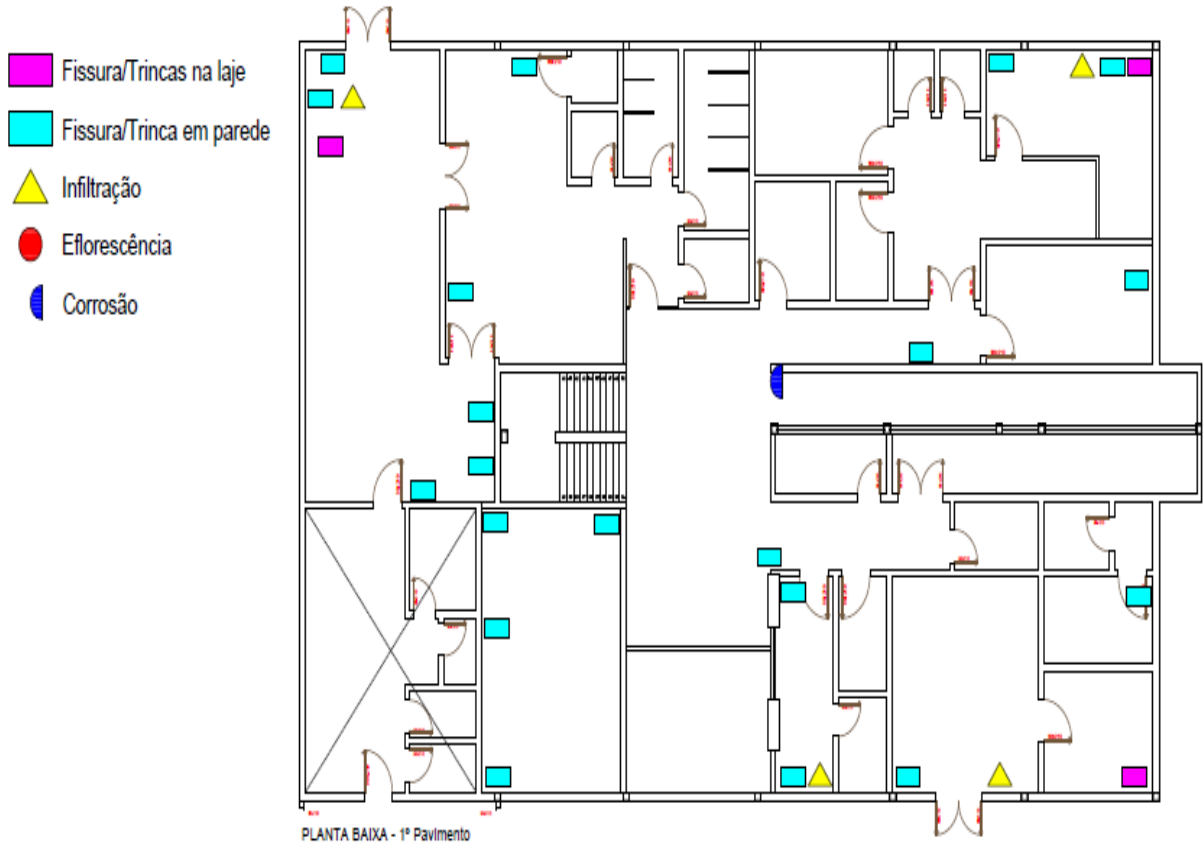
Figura 35: Mapeamento das manifestações patológicas do 1º pavimento.
