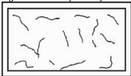
Figura 17: Fissura por retração do concreto.
