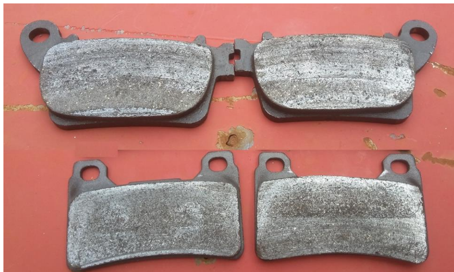
Figura 14 – Pastilhas de freio traseiras (superiores) e dianteiras (inferiores) 50% desgaste, após teste.
