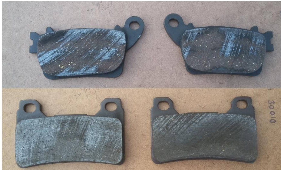
Figura 13 – Pastilhas de freio traseiras (superiores) e dianteiras (inferiores) 25% desgaste, após teste.
