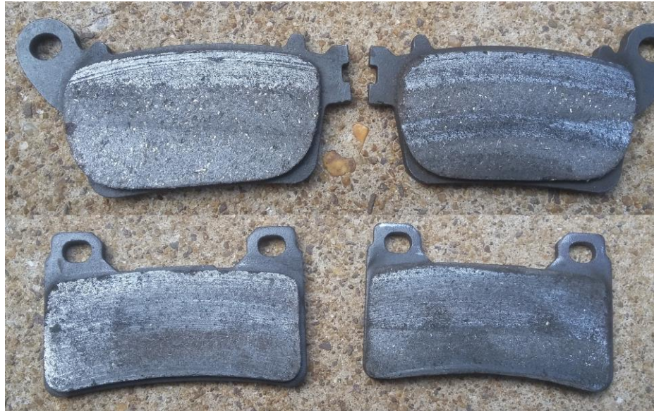
Figura 15 – Pastilhas de freio traseiras (superiores) e dianteiras (inferiores) 75% desgaste, após teste.
