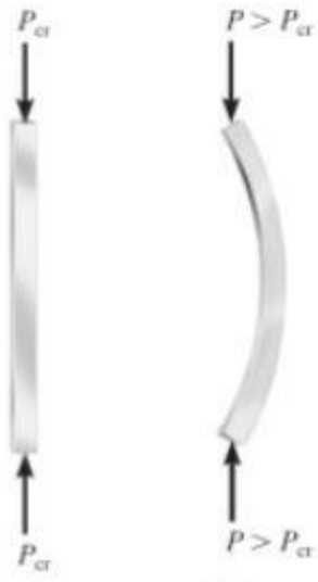
Figura 7 – Coluna sujeita a carga
