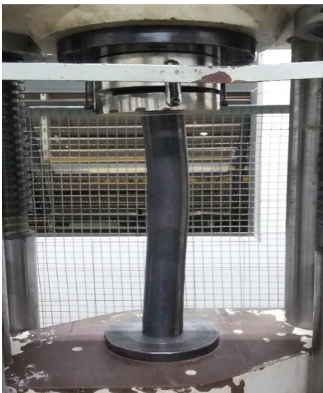
Figura 18 – Sinal visual de deformação no ensaio de compressão
