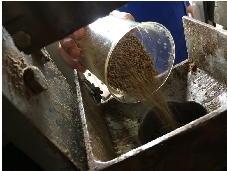
Figura 9- Abastecimento da prensa com crambe.
