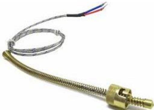
Figura 1 - Termopar tipo J
