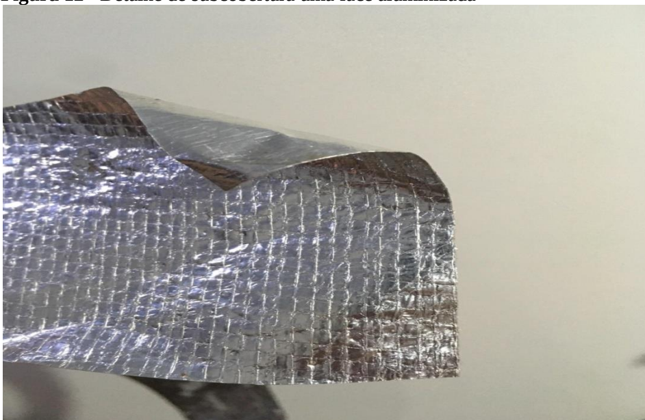
Figura 12 - Detalhe de subcobertura uma face aluminizada
