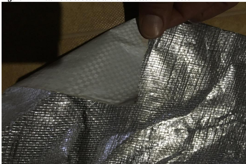
Figura 11 - Detalhe de subcobertura duas faces aluminizadas
