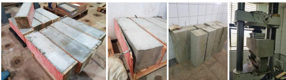
Figura 37: Amostras padrão normatizada pela NBR 12142:2010 com traspases diversos no 12º dia, processo de desformas e posicionamento na máquina de rompimento.
