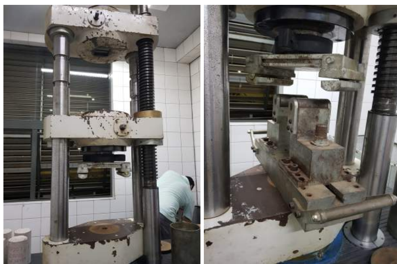
Figura 36: Prensa com acessórios suportes de apoio (cutelos) e descarga de esforços normatizados do laboratório de ensaios da FAG
