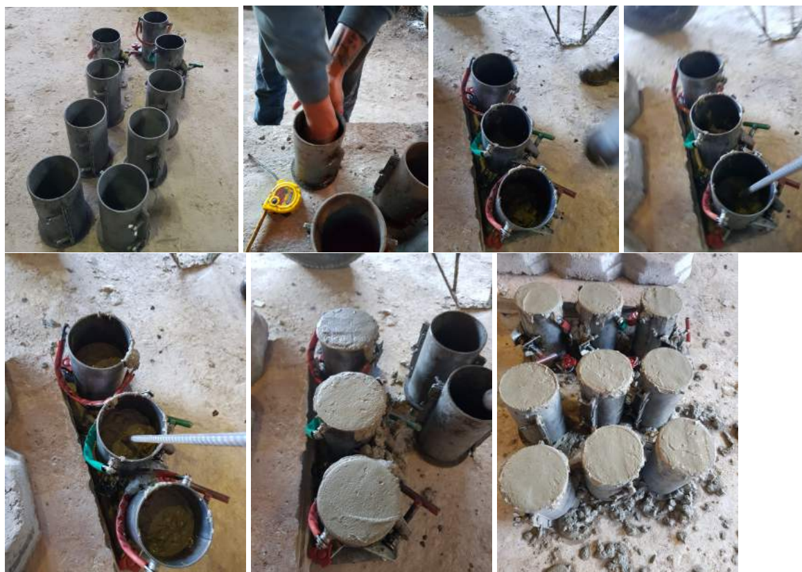
Figura 26: Processo de moldagem dos corpos de provas com o concreto fresco
