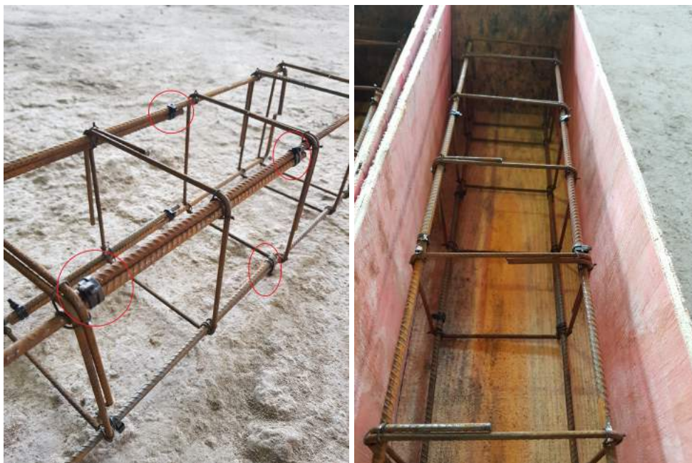
Figura 32: Amostra padrão normatizada pela NBR 12142:2010 com traspases amarradas com abraçadeiras de nylon .
