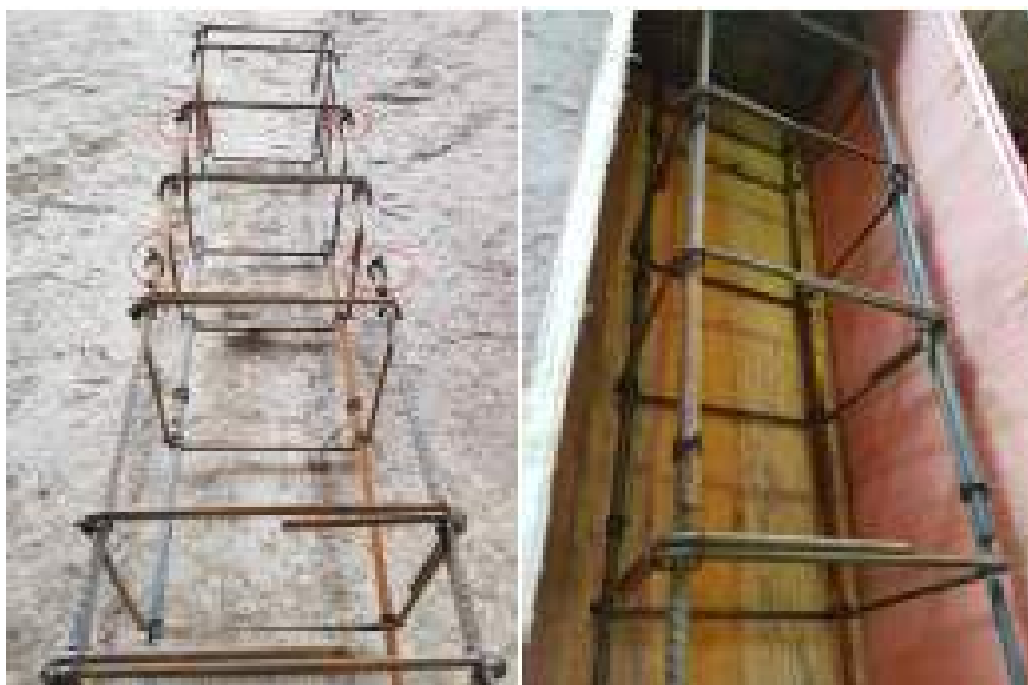
Figura 30: Amostra padrão normatizada pela NBR 12142:2010 com traspases amarradas com arame recozido.
