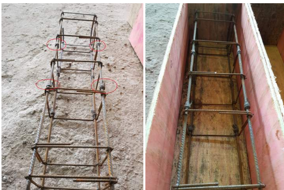
Figura 31: Amostra padrão normatizada pela NBR 12142:2010 com traspases amarradas com descartes de borrachas.
