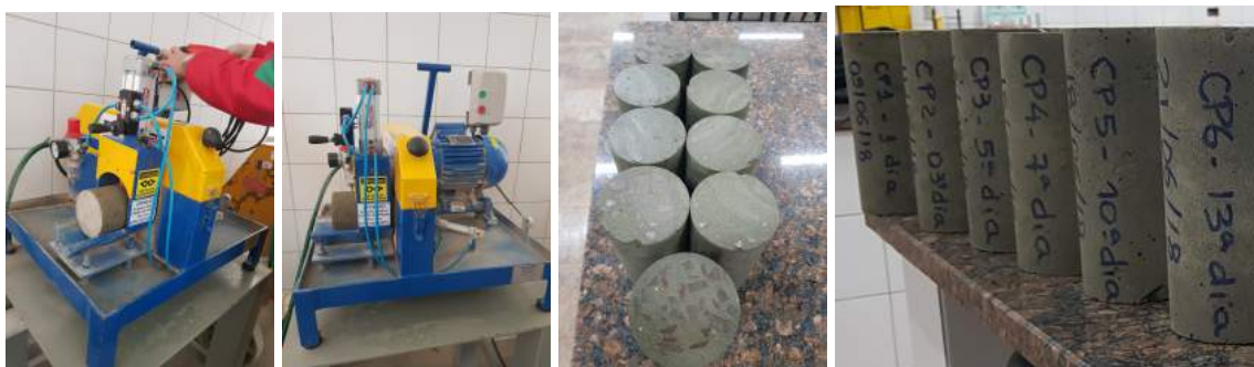
Figura 27: Processo de fresagem dos corpos de provas e identificação
