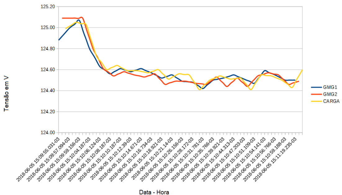
Figura 24: Comportamento da tensão média de fase-neutro durante o acoplamento.
