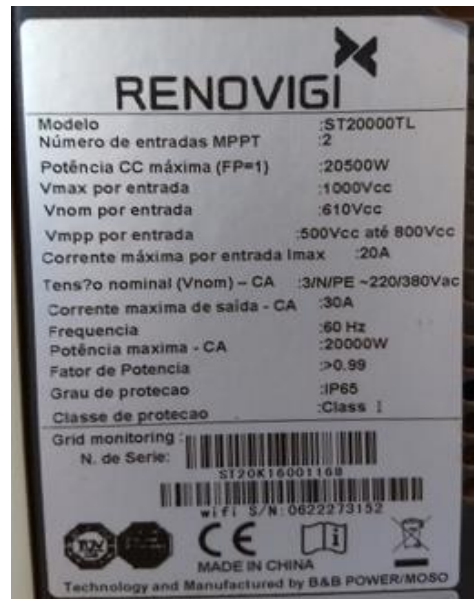
Figura 21 – Placa de dados emitida pelo fabricante dos inversores.
