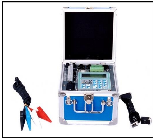
Figura 17 – Analisador de Grandezas Elétricas RMS modelo MARH-21.
