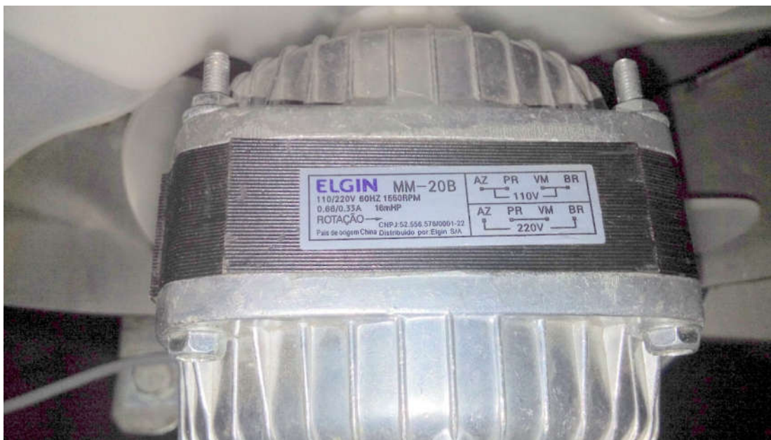
Figura 21: Dados do motor de ventilação do sistema.
