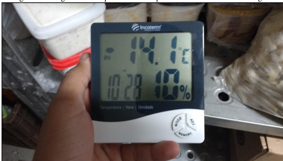
Figura 12 - Registro da temperatura com a porta aberta e a cortina de ar ligada.
