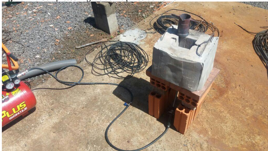
Figura 17: Compressor ligado ao maçarico do Forno
