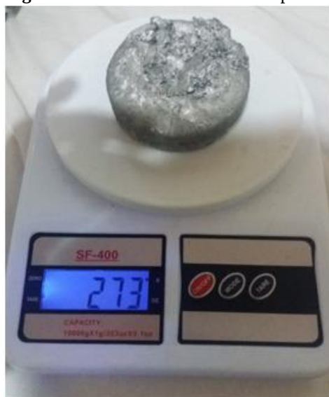
Figura 19: Alumínio fundido sendo pesado após os testes.
