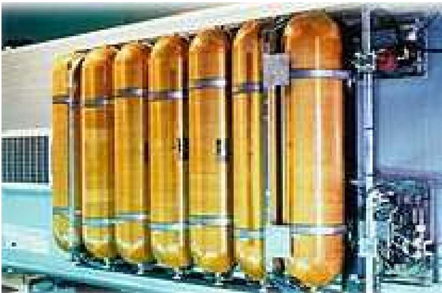
Figura 7: Reservatório de gás de hidrogênio de alta pressão.
