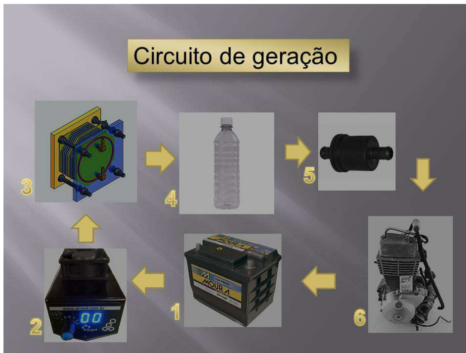
Figura 8: Circuito ideal para funcionamento do motor.
