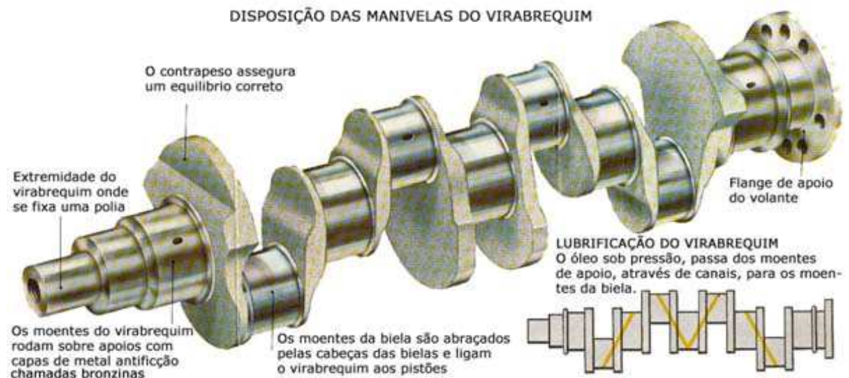
Figura 2: Componentes da árvore de manivela (virabrequim).
