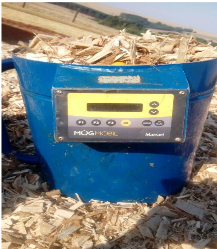
Figura 18: Medidor de Umidade.
