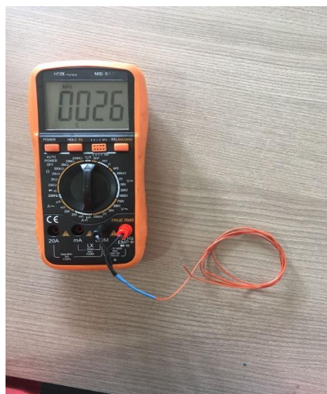
Figura 11 - Multímetro modelo Icel MD6130 e sensor NTC na ponta.
