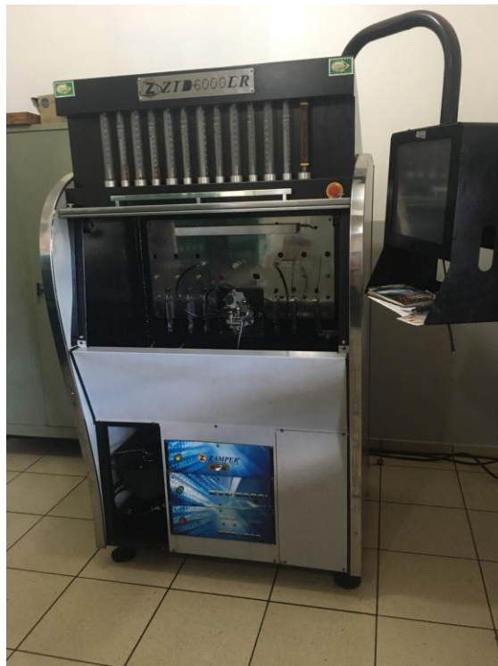
Figura 8 - Máquina utilizada para controle da eletroválvula modelo Zampar ZTD 6000CR
