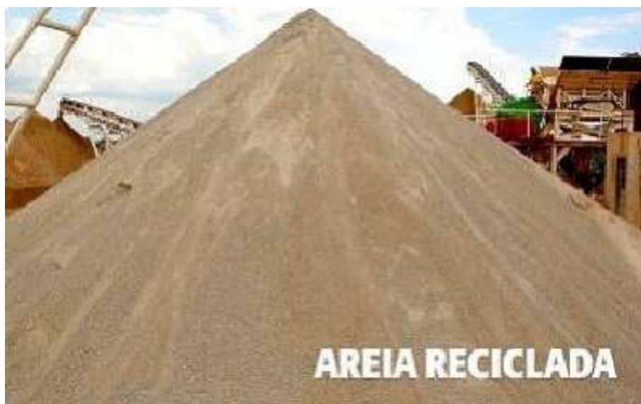
Figura 19: Areia reciclada, obtida diretamente da britagem de resíduos de concreto da construção civil e demolição
