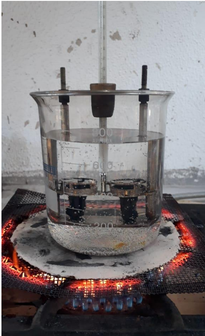
Figura 8. Ensaio de determinação do ponto de amolecimento
