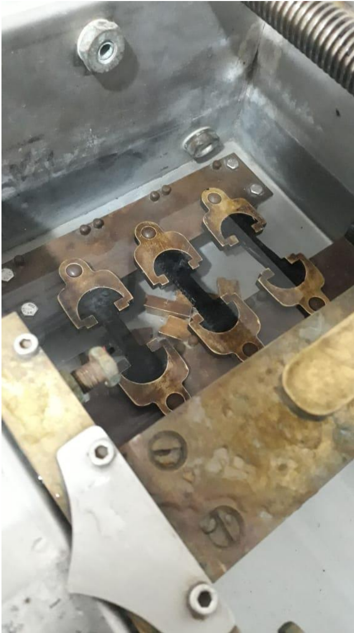
Figura 11. Ensaio de determinação da recuperação elástica
