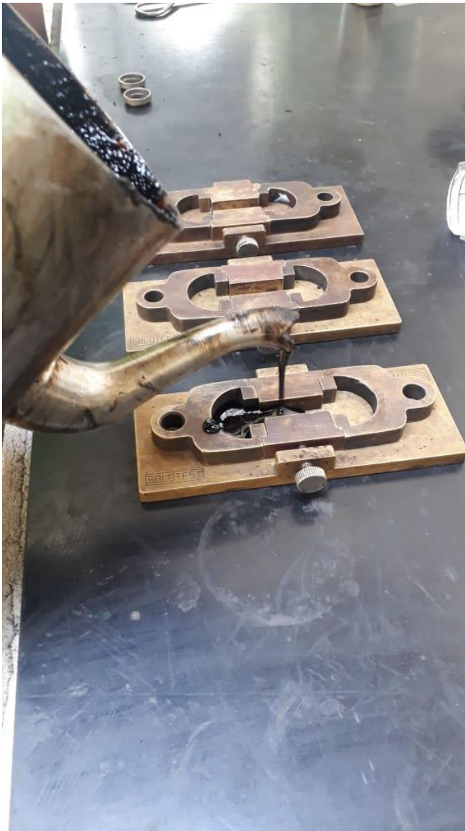
Figura 10. Preparação para o ensaio de recuperação elástica
