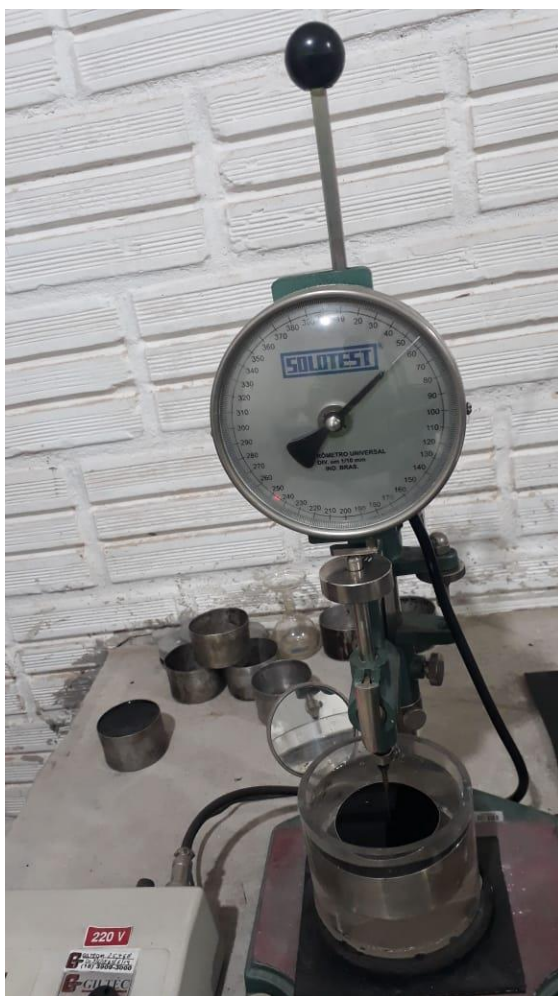
Figura 9. Ensaio de determinação da penetração
