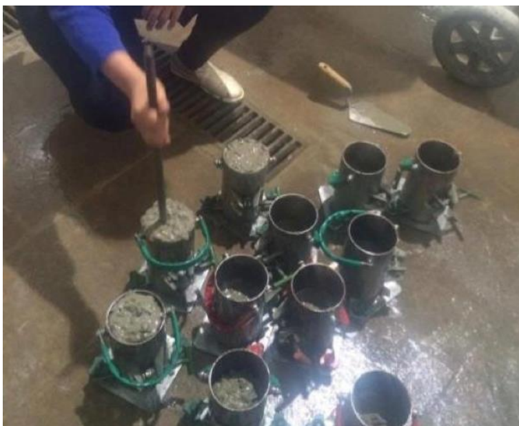
Figura 3: Adensamento do concreto
