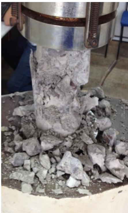
Figura 10: Ruptura corpo de prova.
