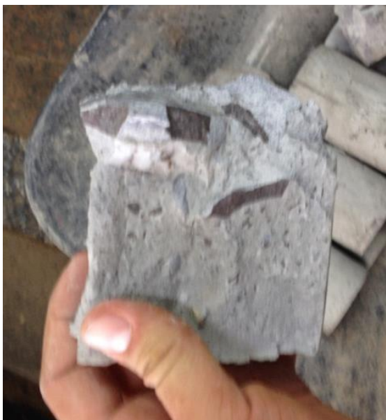
Figura 11: Ruptura do agregado.
