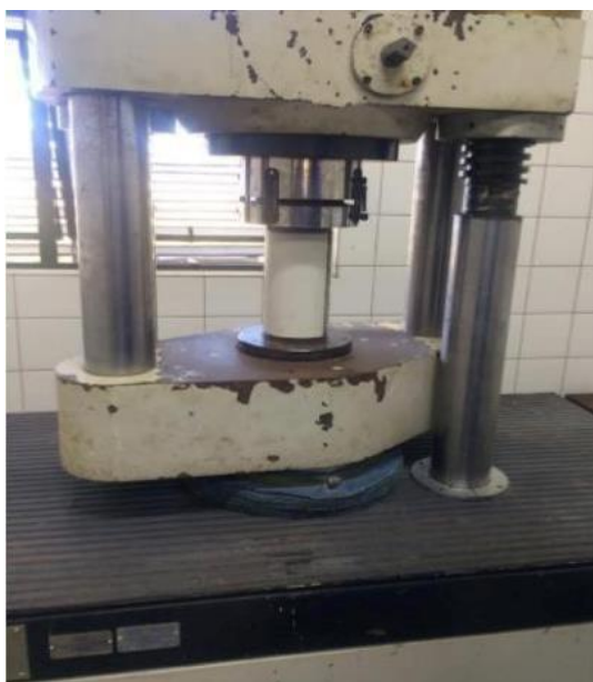
Figura 5: Ensaio de compressão simples.
