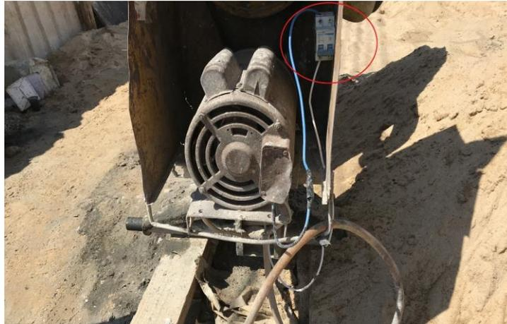
**Figura 17** - Amostra B, acionamento por disjuntor eletromecânico.
