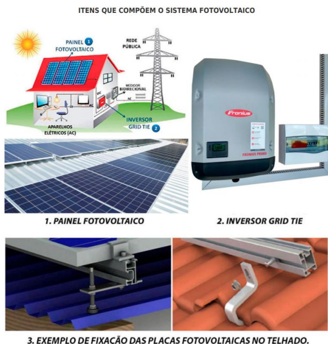
Figura 11 – Itens placa fotovoltaica.
