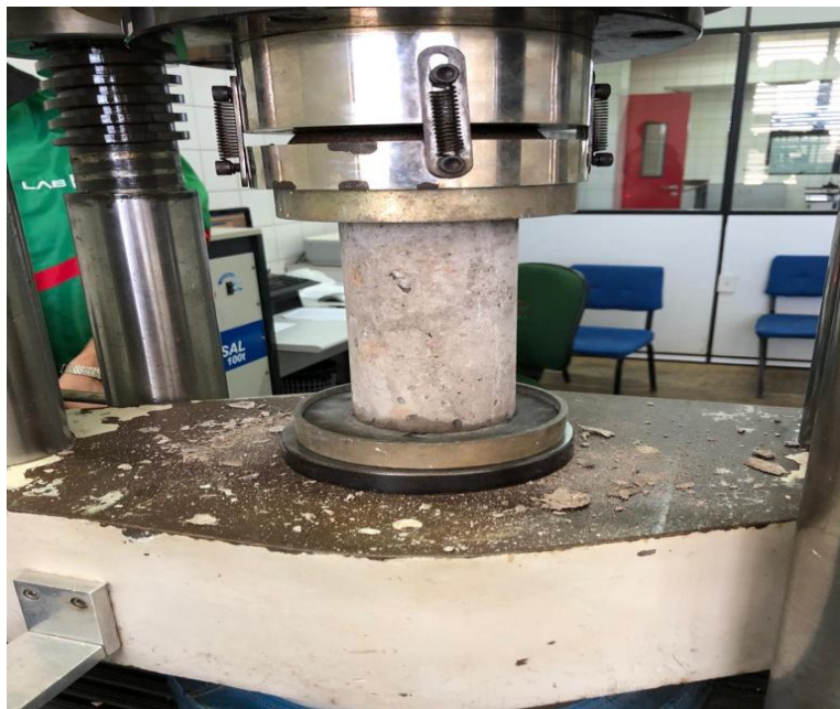
Figura 10 – Teste de compressão em corpo de prova retificado e com neoprene
