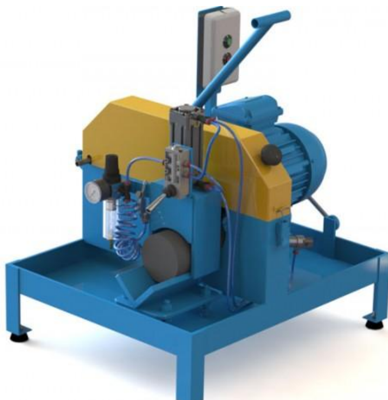
Figura 3: Modelo de retífica faceadora corpo de prova semimanual:
