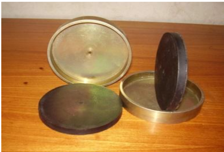
Figura 2: Confinador metálico e bolachas de neoprene:
