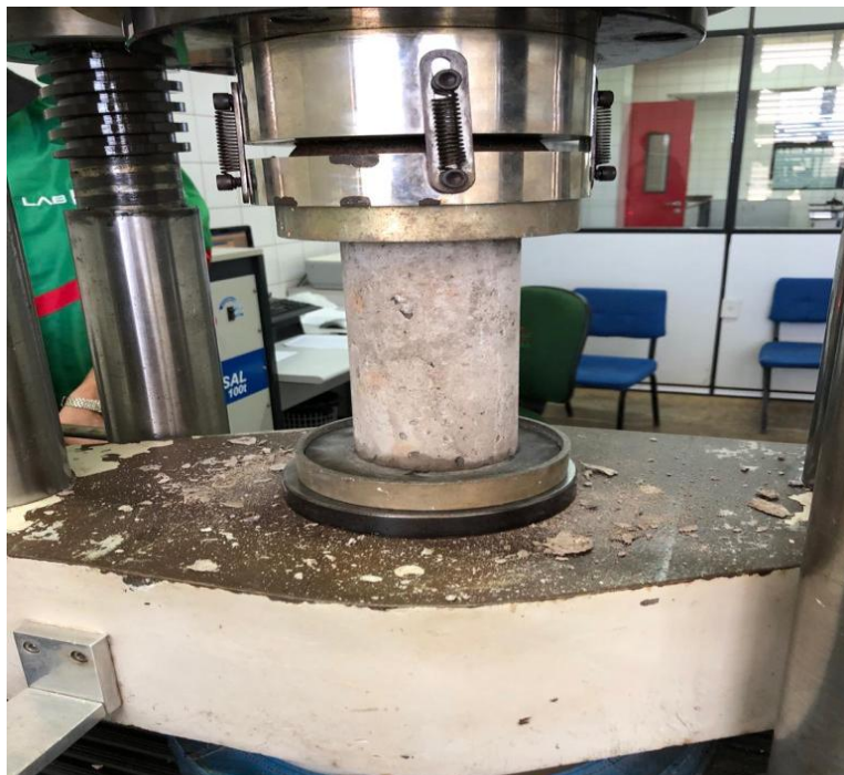
Figura 14 – Teste de compressão em corpo de prova sem retifica e com neoprene
