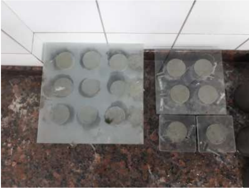
Figura 8: Corpos de prova de argamassa com sua superfície coberta por vidro.
