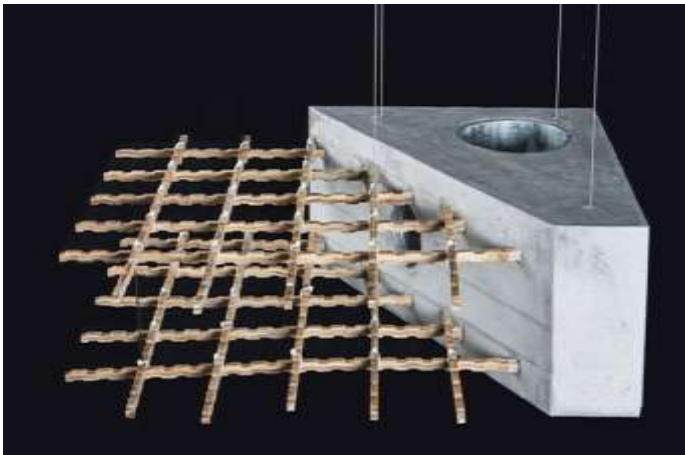
Figura 2: Armadura de Bambu.
