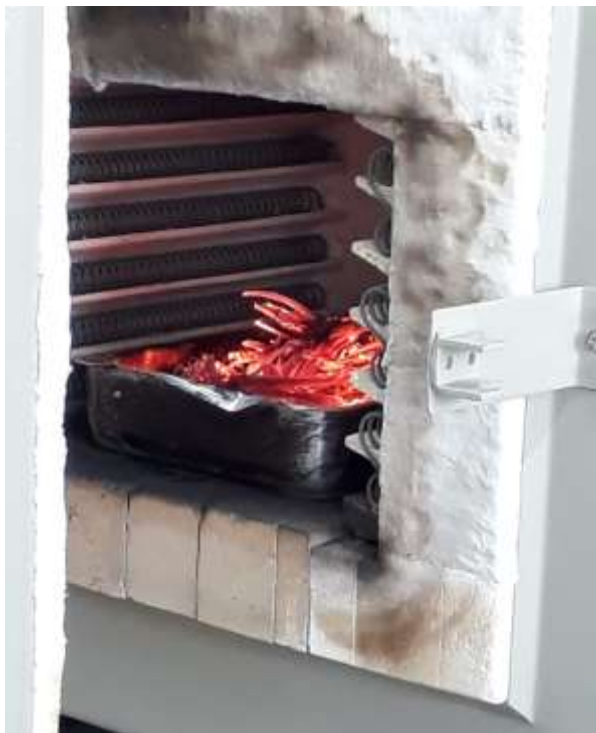
Figura 3: Processo de queima do bambu.
