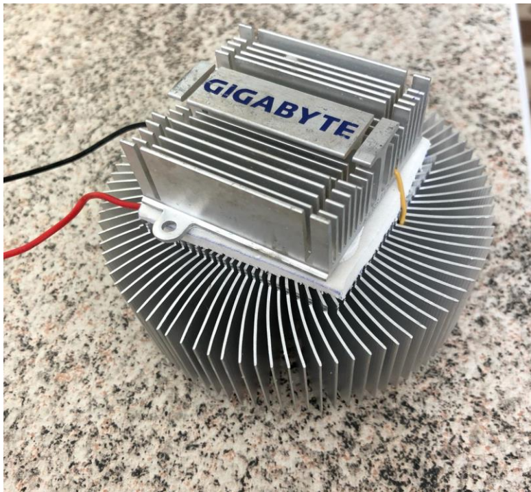
Figura 16 – Placa isolada entre dissipadores
