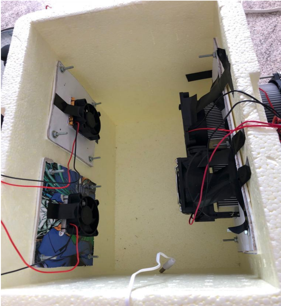
Figura 21 – Visão interna da caixa com coolers internos presos.
