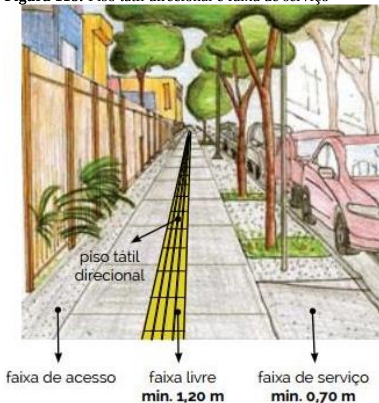
Figura 118: Piso tátil direcional e faixa de serviço
