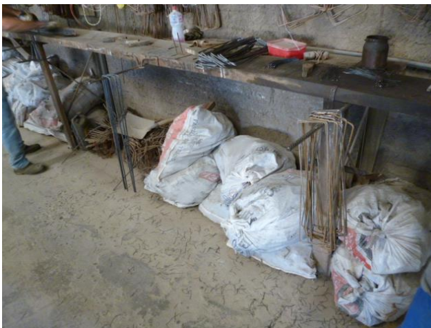
Figura 19: Material não armazenado corretamente
